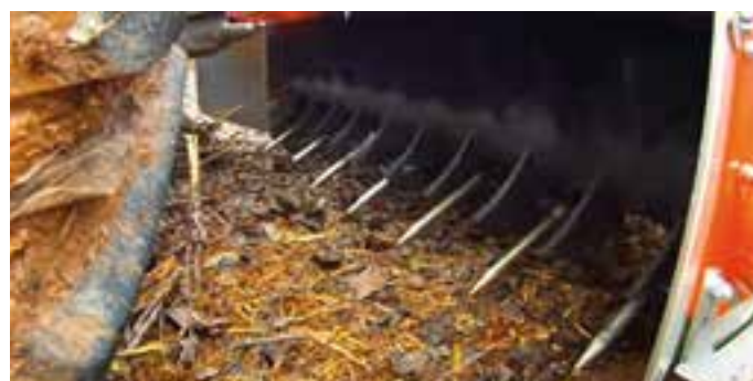
In de versie van Kuhn zit er vóór en onder de invoerrotor nog een systeem van scheppinnen die de takken oplichten.
