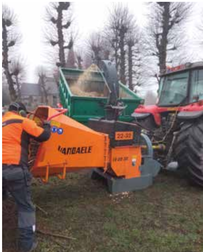
De Vandaale TV22-32 hakselaar is vooral handig voor het verhakselen van snoeiafval langs de wegen.
