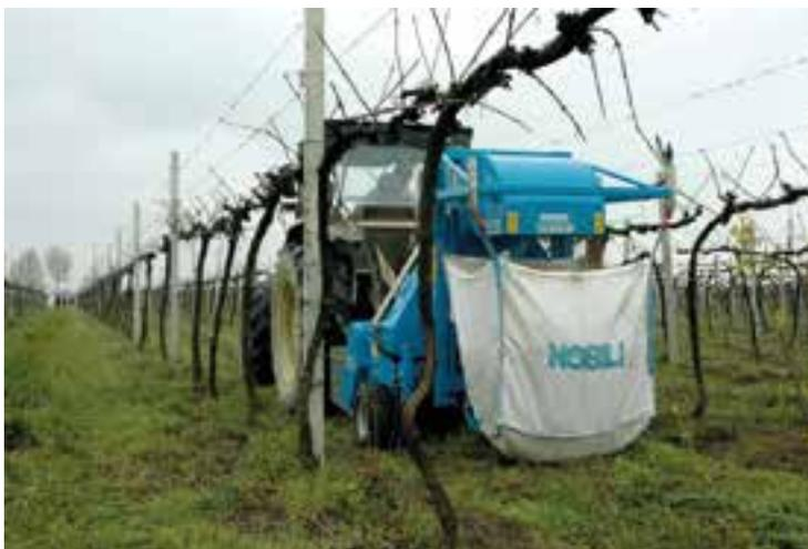
Le fabricant propose ce TRP dans une version avec goulotte d'éjection pour souffler la matière broyée dans une remorque, une version avec une goulotte d'éjection gauche et droite et une version qui recueille la matière broyée dans un big bag ou un palox.
