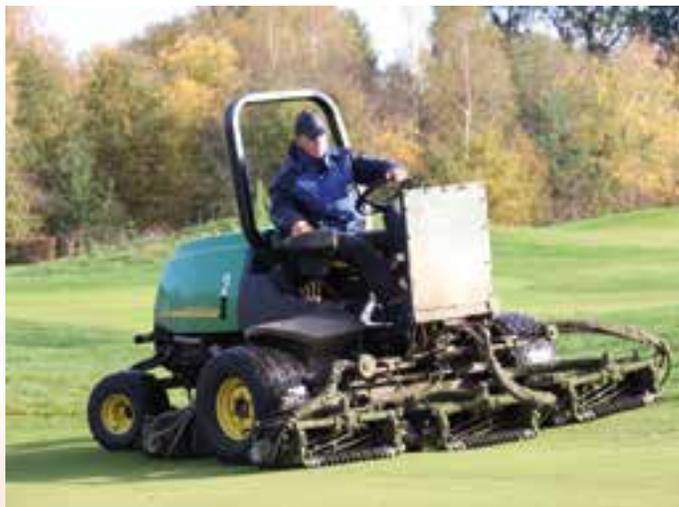
Pour protéger les chauffeurs du froid, une plaque en plastique spéciale est placée devant la console du conducteur des tondeuses au début de l'automne.
