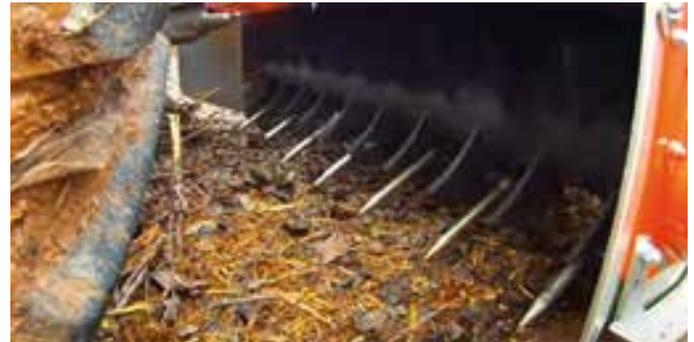
Sur la version Kuhn, on retrouve devant et en-dessous du rotor d'alimentation un système de palpeurs qui soulèvent les branches.
