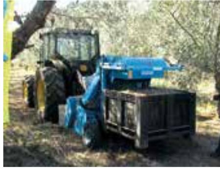
Le TRP peut également être équipé d'une plate-forme de transport pour les palox.
