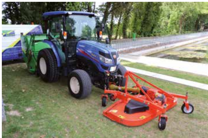
Het Lokaal Bestuur heeft sinds kort een volledig nieuwe combinatie van een Iseki TG met in de front een 180 centimeter brede Italiaanse frontmaaier van Sicma en in de achterhef de Panther Professional-klepeldmaaier met opvang van het Italiaanse Peruzzo.
