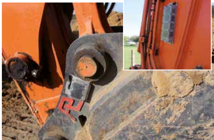
De sensoren op de arm, de giek en de bak meten de hoeken.
