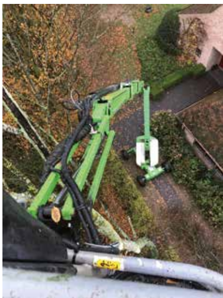
'We investeerden bijvoorbeeld in een hoogtewerker: dat maakt dat we niet meer altijd in een boom moeten klimmen en het verhoogt onze eigen veiligheid.'
