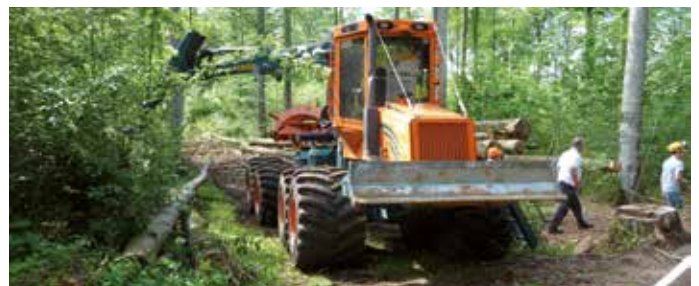
Veel wielen en brede banden zorgen voor weinig bodemverdichting.
