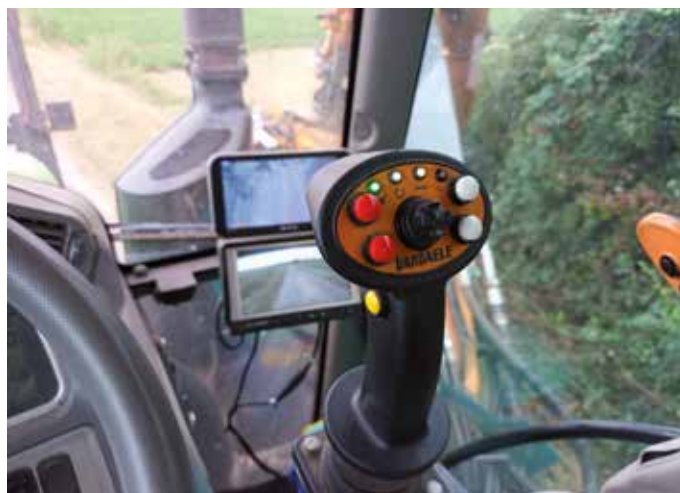
Zicht op de joystick om de arm te bedienen
