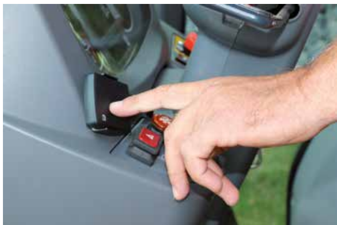
La ville de Grammont a lancé cette année un système de suivi et de traçage axé sur Ecodrive. À cette fin, des lecteurs de badges ont été installés dans tous les véhicules afin de pouvoir suivre et adapter le style de conduite de chaque conducteur.
