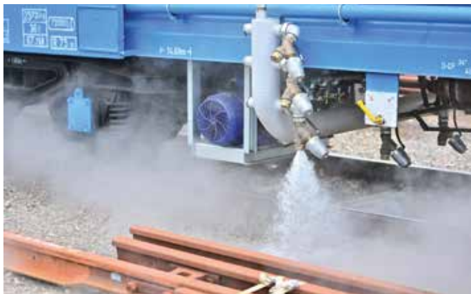
Deux buses sont situées de part et d'autre des citernes pour traiter les voies de sécurité latérales. Quatre autres se trouvent sous les citernes afin de traiter spécifiquement le ballast.
