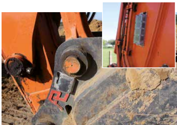
Les capteurs sur le bras, la flèche et le godet mesurent les angles.
