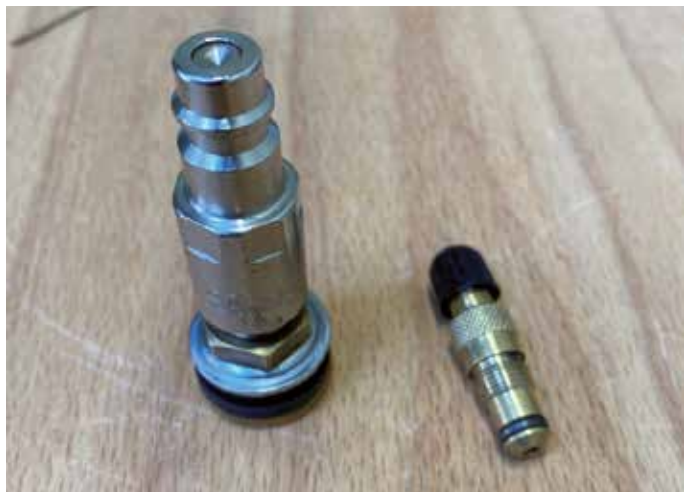
Valve avec embout d'insertion de prise d'air monté avec clapet antiretour
