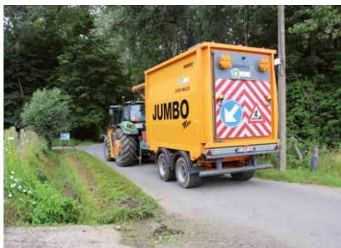
La remorque aspirante a une capacité de 20 m³.
