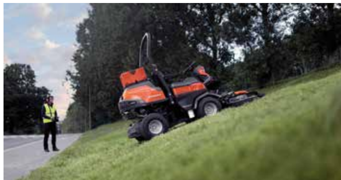
Par exemple, la P524XR EFI, dont le lancement est prévu l'année prochaine, sera dotée d'une télécommande qui lui permettra de travailler en toute sécurité sur les pentes.
