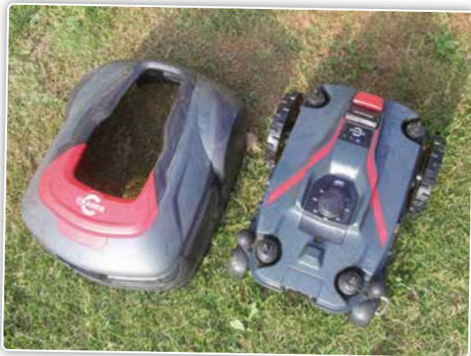
De romp of het lijf van de maaier hangt aan 4 punten op en kan makkelijk worden gedemonteerd om de maaier intensief te reinigen.
