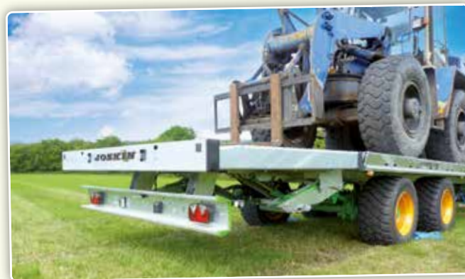
De laadbrug van 2,35 m breed kan hydraulisch worden neergelaten en opgeheven. In opgeheven toestand kan ze de laadbodem met circa 1,5 meter verlengen.
