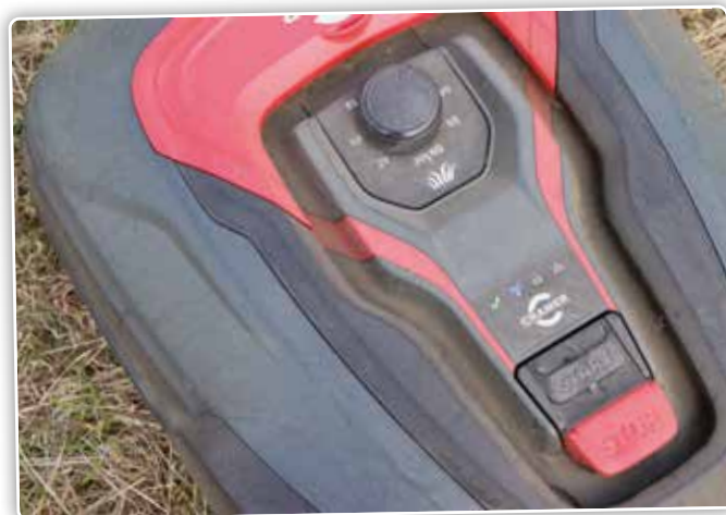
De RM2700 die we op test hadden, is de eenvoud zelf: een stop-startknop en een paneeltje met een waarschuwinglampje voor in bedrijf, connectie, veiligheid of storing. De robot is voorzien van een regen- en ijsensor.
