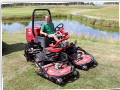
De Toro Groundsmaster 3500 met 3 maaikooien met Sidewinder-systeem kan makkelijker om bunkers heen.
