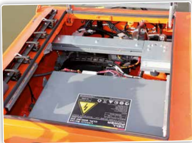
Bij deze maaiboot kan de machinist het accupakket verschuiven zodat de boot altijd horizontaal ligt. Als bijvoorbeeld de maaiboot naar buiten zwenkt en de boot gaat hellen, dan kan via de bedieningsconsole het accupakket worden verschoven zodat hij weer waterpas ligt.
