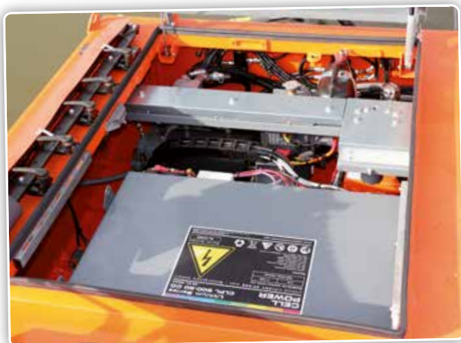
L'opérateur peut déplacer la batterie afin que le bateau reste toujours horizontal. Lorsqu'il éloigne le bras de fauche et que le bateau commence à s'incliner, il peut facilement corriger cela avec la console de commande en déplaçant la batterie.
