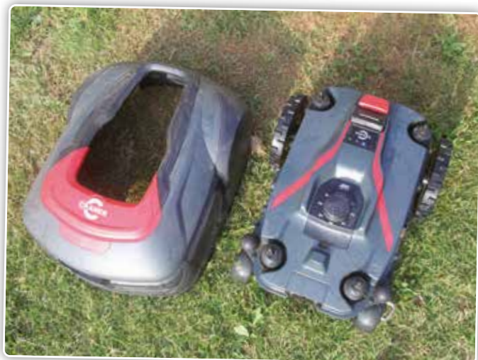
La coque ou le corps de la tondeuse est suspendu à 4 points et peut facilement être démonté pour nettoyer intensivement la tondeuse.
