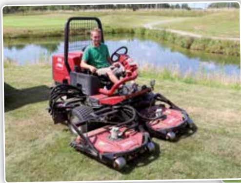
La Toro Groundsmaster 3500 à 3 cylindres de coupe et système Sidewinder permet de contourner plus facilement les bunkers.
