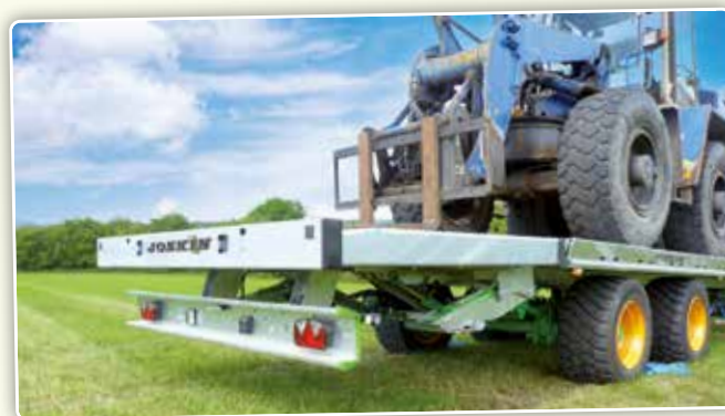
La rampe de chargement de 2,35 m de large peut être abaissée et soulevée hydrauliquement. Lorsqu'elle est relevée, elle permet d'allonger la surface de chargement d'environ 1,5 m.
