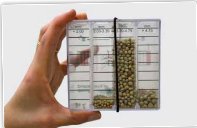
De dichtheid en deeltjesgrootte van de gebruikte meststoffen beïnvloeden de hoeveelheid die wordt aangebracht.
