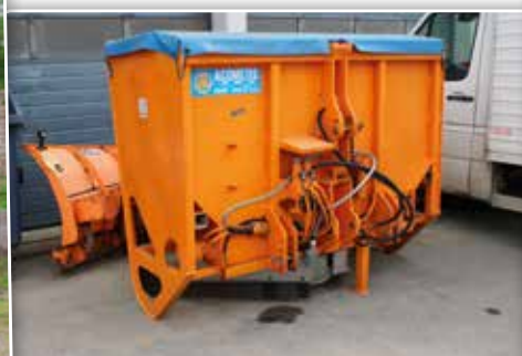
Tijdens de winterperiode zal de bestaande zoutstrooier aan de nieuwe VSV worden gekoppeld.
