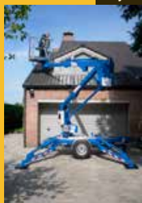
Type 120NWT Werkhoogte 12M Zijdelings bereik 6,5M
