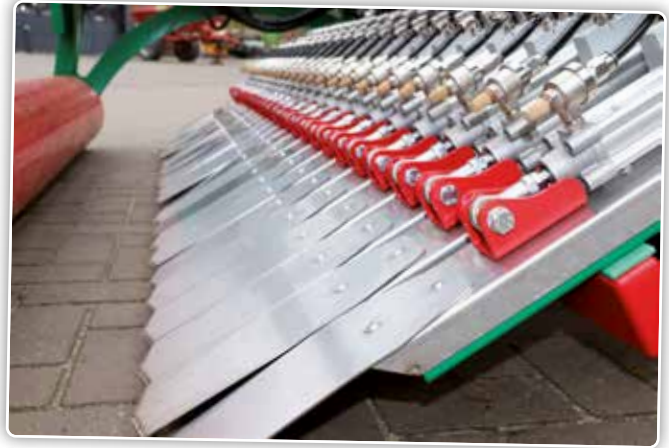
De steekmessen worden aangestuurd door de cameraherkenning. Wanneer er bijvoorbeeld een paardenbloem of ander onkruid precies tussen twee steekmessen in staat, steken twee messen tegelijk zodat het onkruid alsnog uitgestoken wordt.
