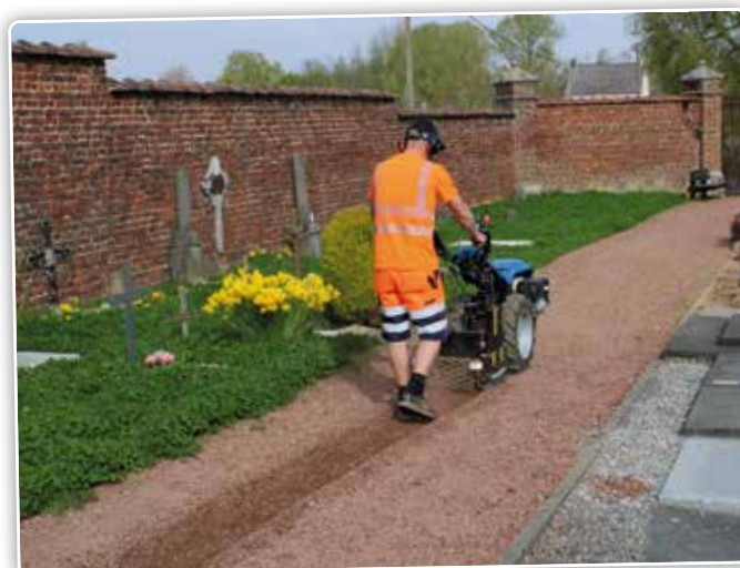
'Om de kerkhoven optimaal te onderhouden, beschikken we over een eenassige trekker met een specifieke frees met omgekeerde messen.'
