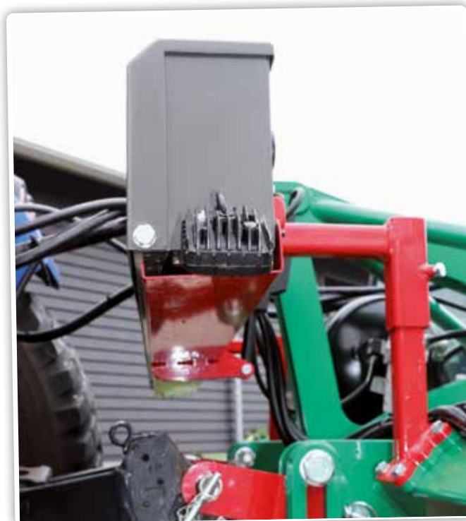
In deze grijze balk (met rode klep aan de onderzijde) zitten de camera's voor de cameraherkenning van het onkruid verscholen.
