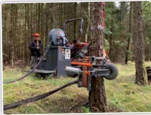
De vertakkingskop bereikt de nodige snelheid via hydraulisch aangedreven rubberen riemen
