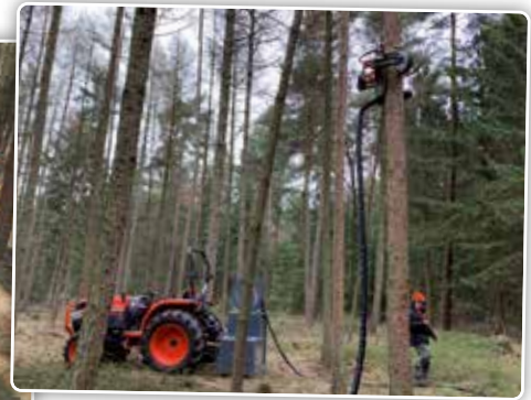
De basis is een aandrijfeenheid in de hef van de trekker of als stationaire hydraulische groep. Het andere deel is de vertakkingskop die vervolgens op de boom werkt.
