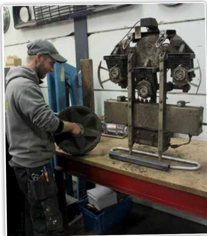
Sommige maairobots rijden tussen 7.000 en 12.000 km/jaar. Bij het jaarlijks onderhoud worden ze grotendeels uit elkaar gehaald.
