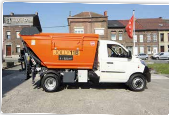
Het chassis dat met een dubbele paraboolveer is afgeveerd is voorzien van een nuttig laadvermogen van 1,6 ton in de versie met dubbele achterwielen.
