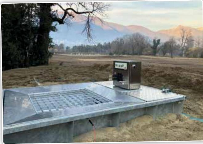
La station de base en métal galvanisé est placée en moyenne à environ 60 à 80 cm de profondeur dans le sol.
