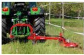
**Débroussailleuses sous clôtures**
