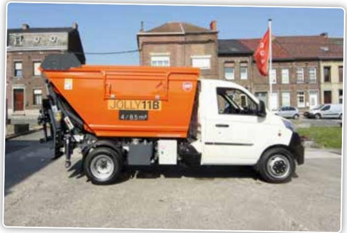
Le châssis à double suspension parabolique est prévu pour accueillir une charge utile de 1,6 tonne sur la version à roues arrières jumelées.
