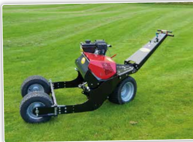
De STrac 700 is een lichte werktuigdrager die nog geen 250 kg weegt en op lagedrukbandjes rijdt. De werktuigen zijn in een paar minuten tijd aangekoppeld of verwisseld.
