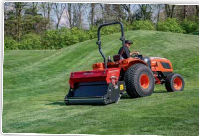
De werkdiepte bij doorzaaien wordt vastgelegd in functie van de bodemstructuur en van de gemeten bodemverdichting.
