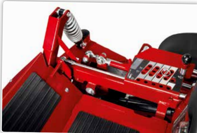
De onafhankelijke wielvering en de ophanging van het maaidek laten een hoge rijsnelheid toe, zelfs op oneffen terrein.
