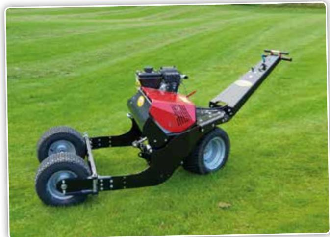
*Le STrac 700 est un porte-outils léger qui pèse moins de 250 kg et est équipé de pneus basse pression. Les outils sont attachés ou échangés en quelques minutes.*
