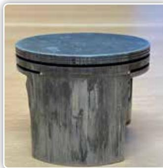
Lorsqu'il y a trop d'air dans le système de lubrification, une oxydation peut se produire, y compris une cavitation et une lubrification plus faible.
