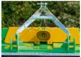
**Système d'attelage flottant permettant un suivi fidèle des reliefs du terrain**
