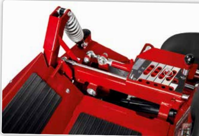
La suspension de roue indépendante et la suspension du carter de coupe permettent une vitesse d'avancement élevée, même sur des terrains accidentés.
