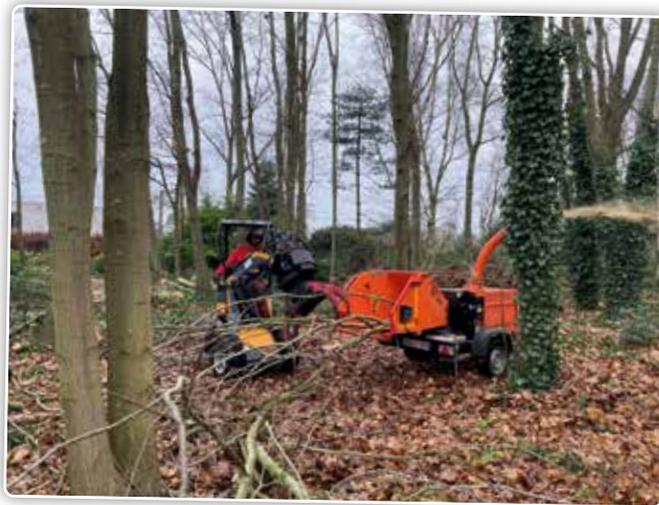
*'Sur le plan de la mécanisation, j'ai ma propre chargeuse articulée compacte et mon broyeur Timberwolf qui me permettent de faire le gros du travail.'*
