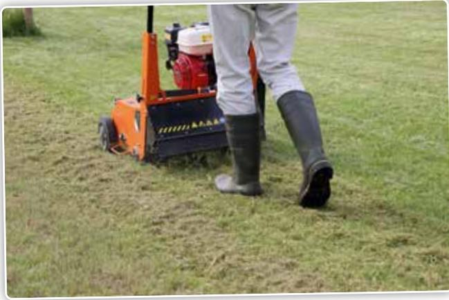
Scarification et évacuation en largeur avec le E550ZR...
