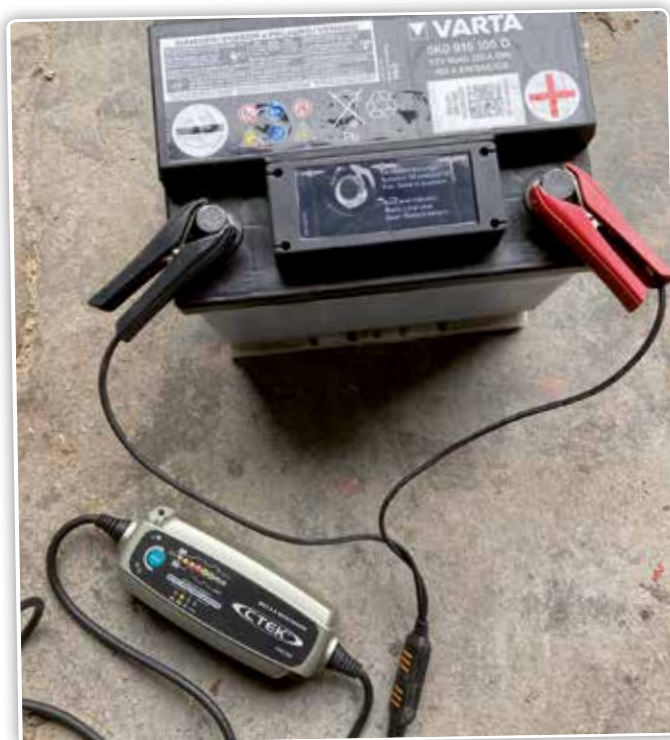
Laad de accu op met een druppellader als onderhoudslader of om de accu echt volgeladen te houden gedurende lange tijd.
