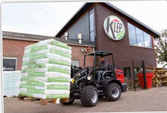
Het theoretische hefvermogen aan de scharnieren achter de koppeling van de X27 als voorbeeld bedraagt 2.300 kg.
