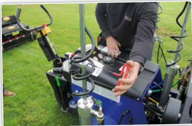
De werkdiepte kan nog geregeld worden door de aanslag aan de cilinders van de voeten te verzetten.
