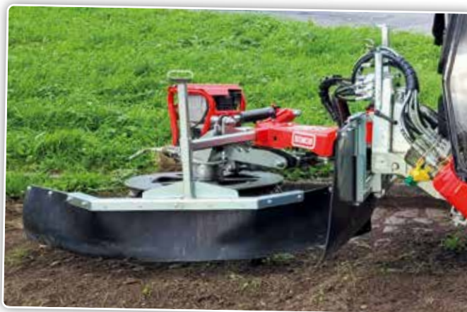
Dankzij de elektrische aandrijving met een 3-fasenmotor beschikt de onkruidborstel over bijna twee keer zoveel koppel en vermogen.
