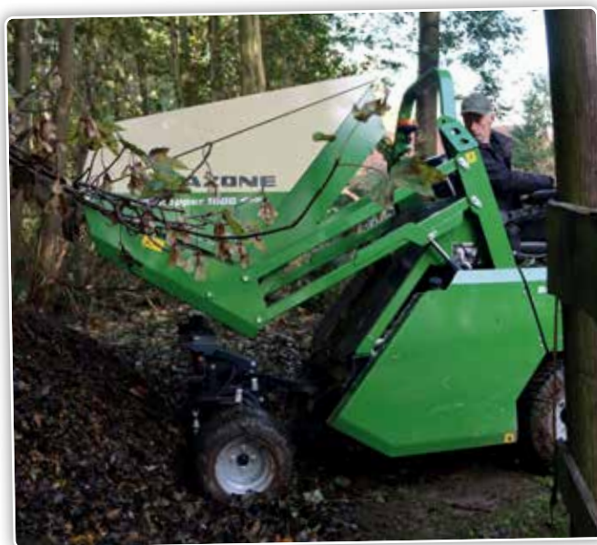
Met de hoogkipinrichting gaat het scharnierpunt van de bak tot op maximum 2,50 m.
