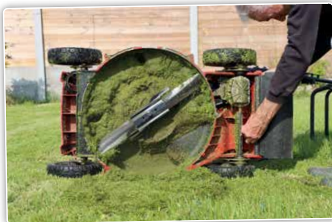
Om te mulchen wordt er een plastic deflector in het uitlaatkanaal geplaatst waardoor het gras nogmaals door het mes gaat.
