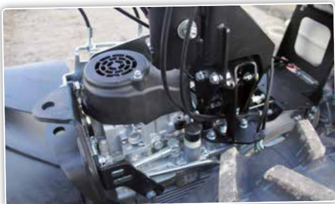
De Stargate hydrostatische transmissie is volledig opnieuw ontworpen waardoor alles ook veel compacter gebouwd is. Zo zit de oliekoeler niet meer op de zijkant, maar bovenaan.
