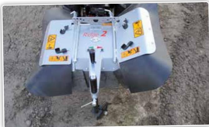
Deze Ridger bestaat in 90 cm en kan met de hulp van flenzen en extra messen naar 1,30 m worden verbreed.
