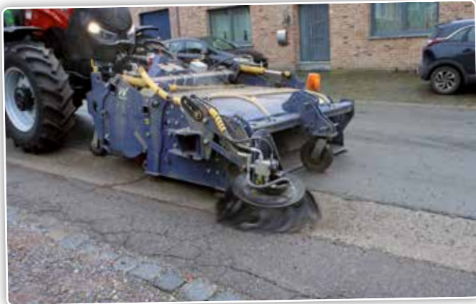
Dankzij de ingebouwde opvangbak, de schrapers over de volledige werkbreedte om de grootste verontreinigingen op te vangen en de hydraulisch aangedreven zijborstel levert deze machine proper werk in de meest uiteenlopende omstandigheden.
