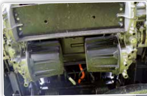
Met de elektrische rijmotoren heeft de maaier een rij-equivalent van een 22pk-brandstofmotor en een maximumsnelheid van 13 km/u.
