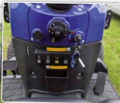
De schakelaars onder het stuur dienen onder meer voor het inschakelen van het hydraulisch stuur, de hefinrichting en de hydrauliek. Met deze schakelaar onder het stuur (rode stip) stel je de rijrichting in, met de andere (gele stip) pas je elektronisch de rijsnelheid aan.
