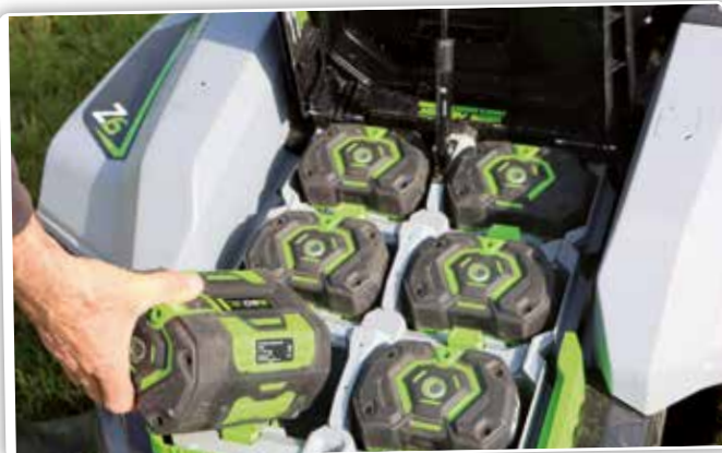
In de praktijk kunnen er tot 6 lithiumionbatterijen van 56 volt in de maaier geplugd worden waardoor er een maximumcapaciteit van 72 Ah (6 x 12 Ah),
