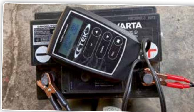
Je kan de accu testen door met een voltmeter de spanning te meten tussen de min- en de pluspool. Een geladen accu heeft 12,7 V, een volledig ontladen accu 12,3 V.
