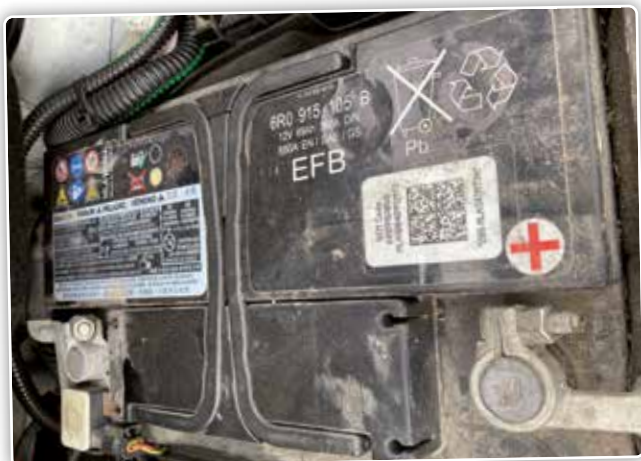
De koudstartstroom (CCA) geeft aan hoeveel stroom of ampère de accu bij een koude omgeving (-18°C) gedurende 30 seconden kan leveren.
