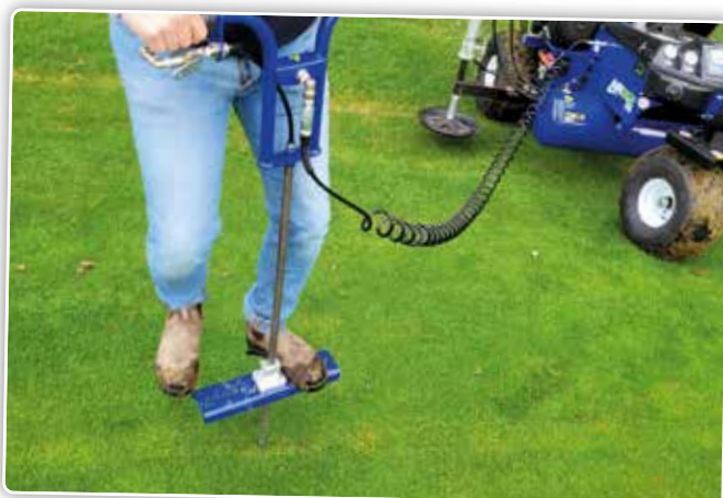
In het pakket zit ook nog een aparte pin die met een aparte drukluchtleiding op de machine kan worden aangekoppeld.
