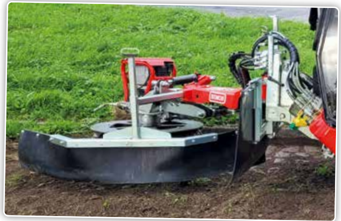
Grâce à l'entraînement électrique triphasé, la brosse à adventices bénéficie près du double de couple et de puissance.
