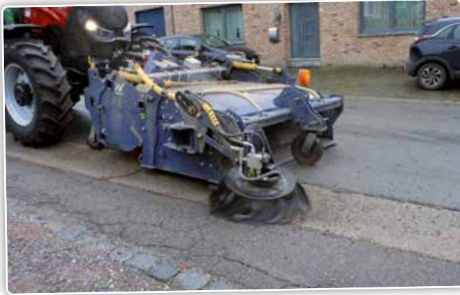
Grâce au bac de collecte intégré, aux racleurs sur toute la largeur de travail pour absorber les plus gros déchets et à la brosse latérale à entraînement hydraulique, cette machine offre un travail propre dans les conditions les plus diverses.
