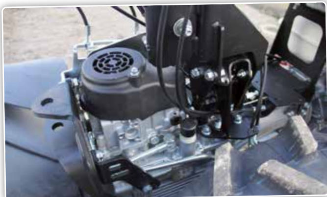
La transmission hydrostatique Stargate a été complètement repensée afin que tout soit également construit de manière beaucoup plus compacte. Le refroidisseur d'huile n'est plus placé sur le côté mais au dessus.
