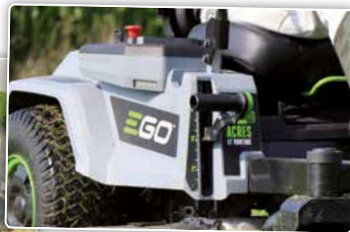
A droite du conducteur se trouve le levier pour le réglage manuel de la hauteur du plateau de coupe. Cela permet de régler le plateau de coupe en acier de 107 cm de large entre 25 et 110 mm dans 10 positions.
