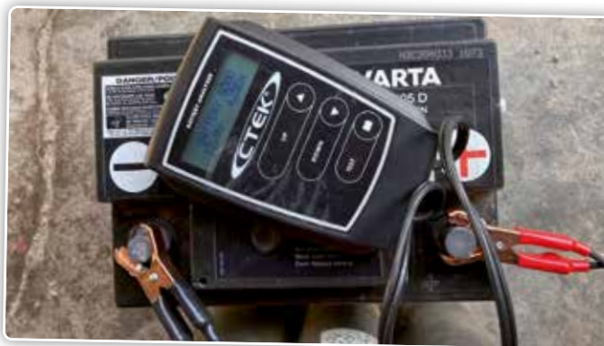
Vous pouvez tester la batterie en mesurant la tension entre le pôle moins et le pôle plus avec un voltmètre. Une batterie chargée mesure 12,7 V, une batterie complètement déchargée mesure 12,3 V.
