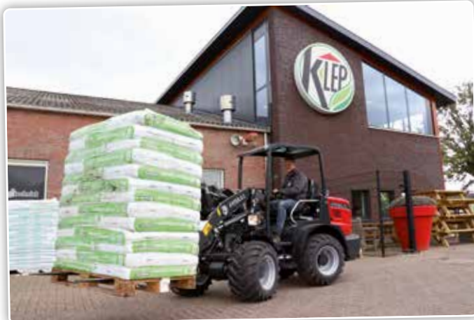
La puissance de levage théorique aux articulations du modèle X27 est de 2.300 kg.
