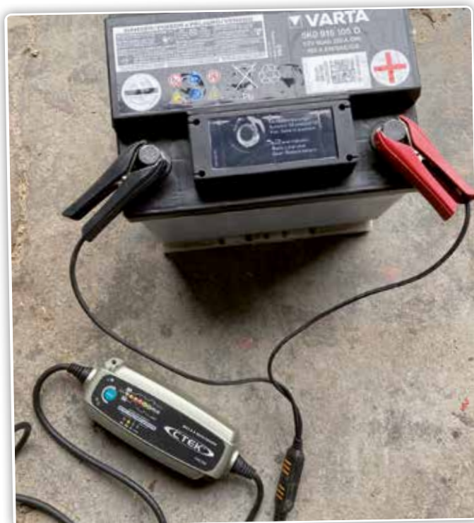
Chargez la batterie avec un chargeur de goutte à goutte comme chargeur d'entretien ou pour garder la batterie vraiment complètement chargée pendant une longue période.
