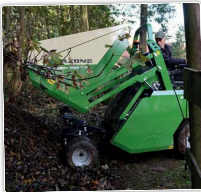
Avec le dispositif de vidange surélevée, l'articulation du bac de collecte se trouve à une hauteur maximale de 2,50 m.
