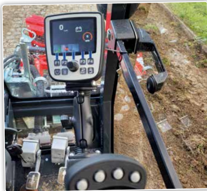
Le Posi-Trac dispose d'un entraînement électrique en continu entièrement automatique avec deux pédales séparées: une pour la marche avant et la seconde pour la marche arrière.
