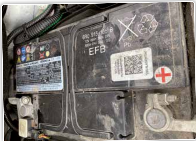
Le courant de démarrage à froid indique la quantité de courant ou d'ampère que la batterie peut fournir pendant 30 secondes dans un environnement froid (-18 °C).
