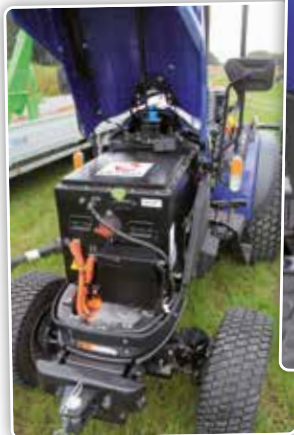
Farmtrac utilise un pack de batteries de 300 Ah.
