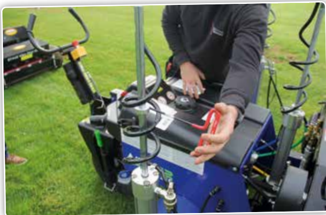
La profondeur de travail peut encore être contrôlée en déplaçant la butée sur les vérins des patins.
