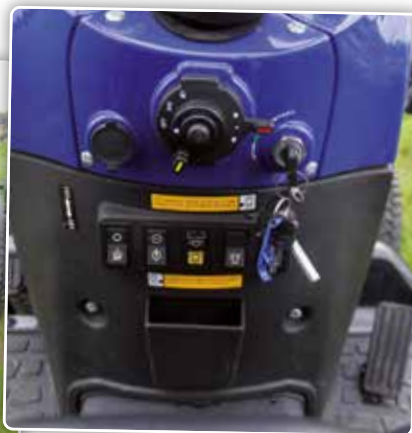
Avec cet interrupteur (ligne rouge) à côté du volant, il est possible de régler le sens d'avancement. L'autre (ligne jaune) permet d'adapter électroniquement la vitesse d'avancement.
