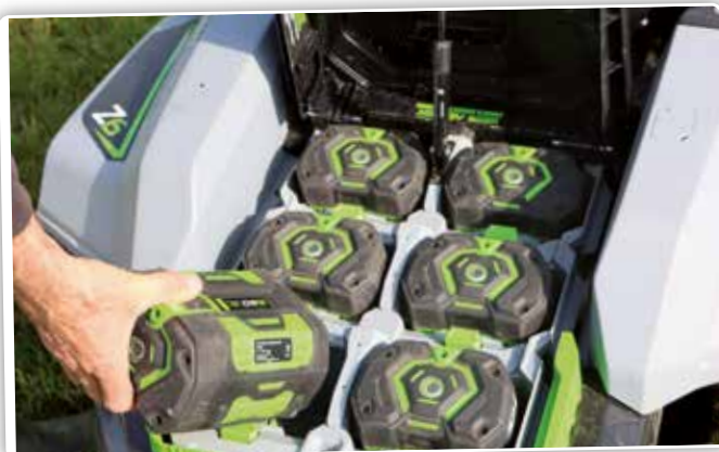
En pratique, jusqu'à 6 batteries Lithium-Ion de 56 Volts peuvent être branchées sur la tondeuse, ce qui offre une capacité maximale de 72 Ah (6 x 12 Ah).
