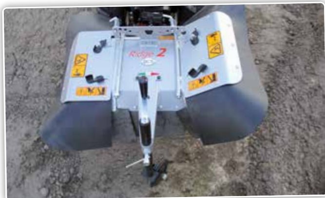
Ce Ridger existe en largeur de travail de 90 cm et peut être élargi à 1,30 m à l'aide de flasques et de couteaux supplémentaires.
