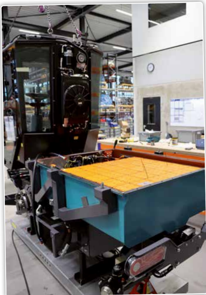
Als de klant kiest voor het laadplatform dan wordt er een extra chassis rond de batterij gezet.
