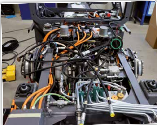
In een maximaal uitgeruste RECO eTrac zijn er dus twee rijwielmotoren en twee elektrisch-hydraulische units.
