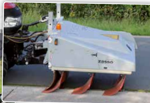
De frontapplicator staat op een beweegbaar frontkader en is uitgerust met 3 rijen statische elektroden.
