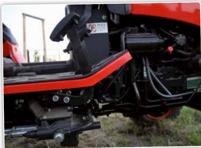
In optie levert Kioti ook een middenaftakas met 2.000 toeren/minuut zodat er bijvoorbeeld een middenmaaier kan worden aangekoppeld.
