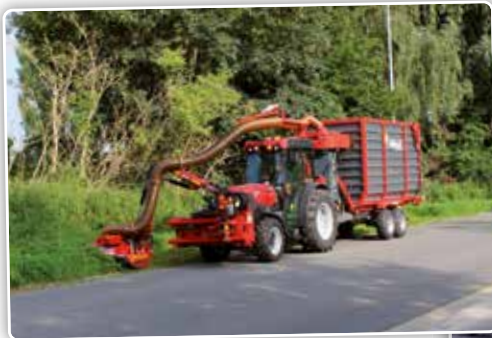
Verder werd ook geïnvesteerd in een maai- zuigcombinatie met een smalspoor om eenvoudiger te kunnen maaien langs fietspaden, tussen aanplantingen en straatmeubilair enz...
