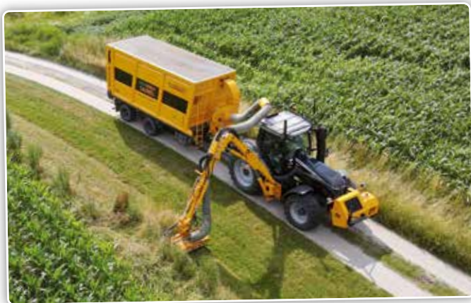
De Deeroo-zuigwagen van Geert Cauwel is voorzien van een gedwongen gestuurde as met assen die ver uit elkaar staan.
