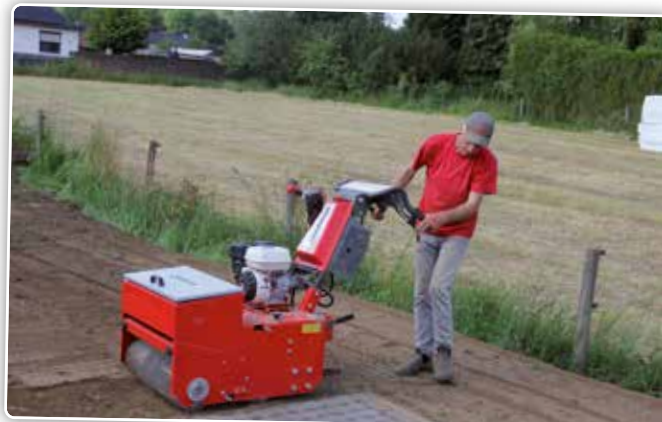
Tot slot komt de aandrukrol die het ingewerkte zaad stevig aandrukt.
