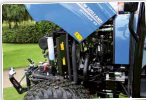
De Boomer 55 is uitgerust met een driebcilindermotor met een maximaal vermogen van 57 pk.
