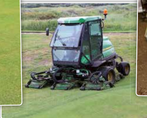
Brackx is ook zeer te spreken over de Maredo-modules. De greens worden doorgezaaid met deze Maredo GT410 VibeSpike-SeederF units.
