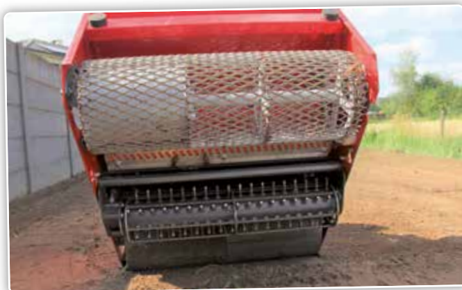
De machine is van voor naar achter opgebouwd uit drie aangedreven rollen: een rasterwals, een prikrol en een aandrukrol uit twee delen met schraper.
