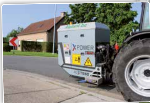
Achteraan op de tractor wordt een generator in de lift bevestigd om stroom op te wekken.
