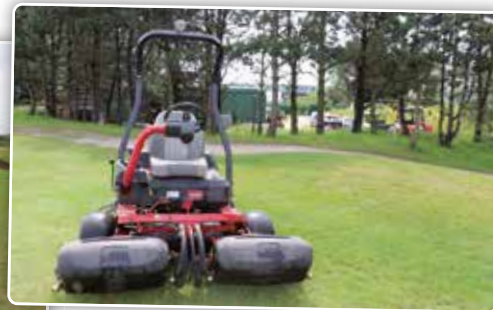
De Koninklijke in Oostende gebruikt een Toro Greensmaster 3250-D met drie maaibakken met 10 messen waarmee de tees en de avant-greens worden gemaaid op 9 millimeter. Met een versie met 11 messen worden de greens gemaaid op 4 millimeter.
