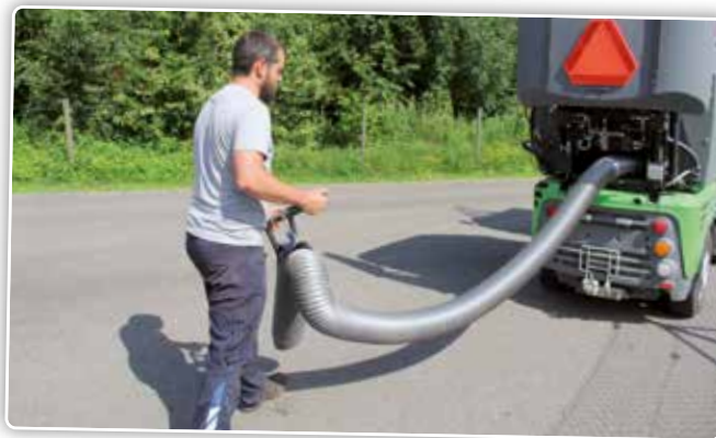
De Egholm heeft een hogedrukreiniger achterin en ook een zuigslang voor bijvoorbeeld bladeren en los vuil.
