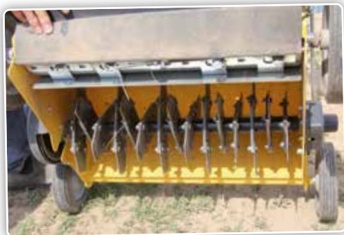
De frees met 15 dubbele messen (30 in totaal) maakt eerst sleufjes in de grond waarna het zaad er wordt ingelegd.
