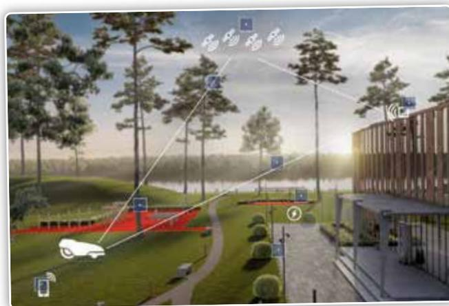
*Grâce au système Epos, la machine sait exactement où elle se trouve à 2 à 3 cm.*
