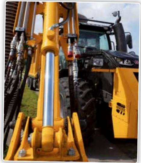
Les pompes du Grenadier et le ventilateur entraîné mécaniquement sur la remorque aspirante sont réglés de telle façon que le tracteur puisse fonctionner à environ 1.500 t/min.
