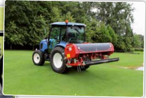
Un capteur placé au-dessus du relevage trois points permet d'arrêter automatiquement la prise de force lorsque l'outil attelé est relevé.
