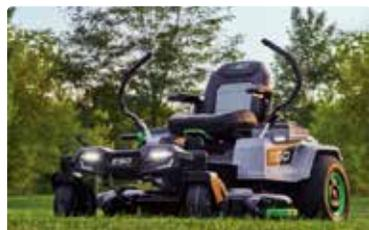
**Le fabricant de machines Ego présente une tondeuse zéro turn entièrement électrique. La machine est équipée d'un maximum de six batteries de 56 volts; les mêmes que sur les autres machines sur batteries d'Ego.**
