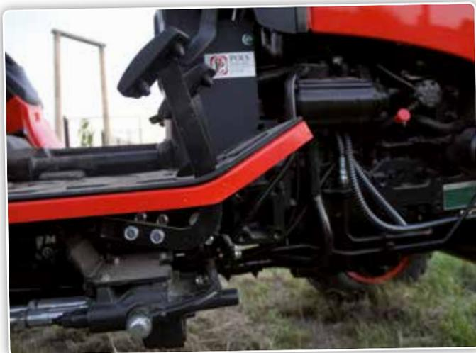
Kioti propose également en option une prise de force ventrale à 2.000 t/min afin de pouvoir par exemple entraîner une tondeuse ventrale.
