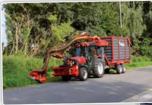
*En outre, la société a investi dans une combinaison de fauche et d'aspiration montée sur un tracteur à voie étroite afin de faucher facilement le long des pistes cyclables, entre les plantations et le mobilier urbain, etc.*
