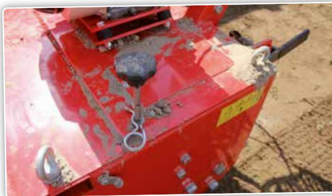
Ce rouleau à pointes est entouré d'un rouleau-cage dont la pression de rappui peut être réglée.
