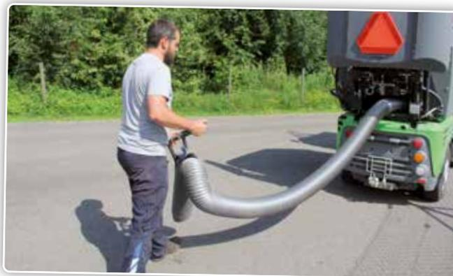
*L'Egholm dispose d'un nettoyeur haute pression à l'arrière et également d'un tuyau d'aspiration pour les feuilles et les saletés.*
