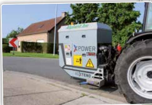
Un générateur est monté sur le relevage arrière du tracteur afin de fournir l'énergie nécessaire.
