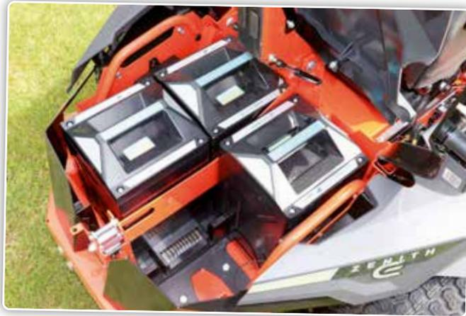
*D'après le constructeur, l'Ariens Zenith E est la première tondeuse à gazon électrique professionnelle avec système de changement rapide des batteries.*
