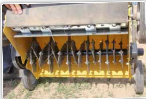
La fraise avec 15 lames doubles (30 au total) réalise d'abord des sillons dans lesquels les semences seront déposées.
