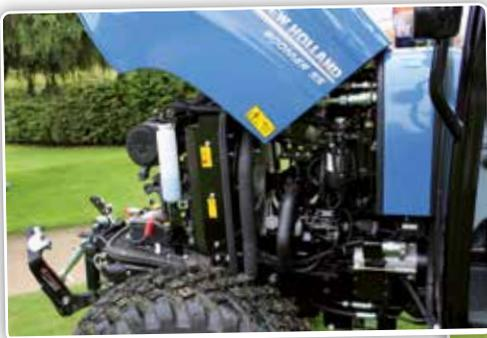
Le Boomer 55 est équipé d'un moteur trois cylindres d'une puissance maximale de 57 ch.
