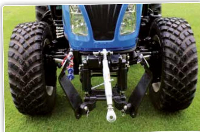
*Un relevage Zuidberg et les connexions hydrauliques nécessaires font partie des équipements en option.*
