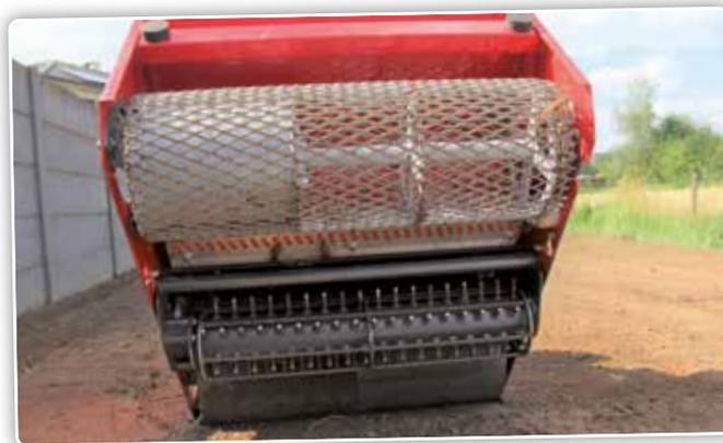
*La machine est composée de trois rouleaux entraînés de l'avant vers l'arrière: un rouleau grillagé, un rouleau à pointes et un rouleau de rappui en deux parties avec grattoir.*
