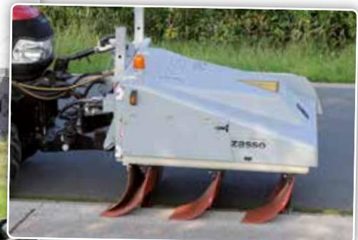
L'applicateur frontal est monté sur un cadre frontal mobile et dispose de 3 rangées d'électrodes statiques.
