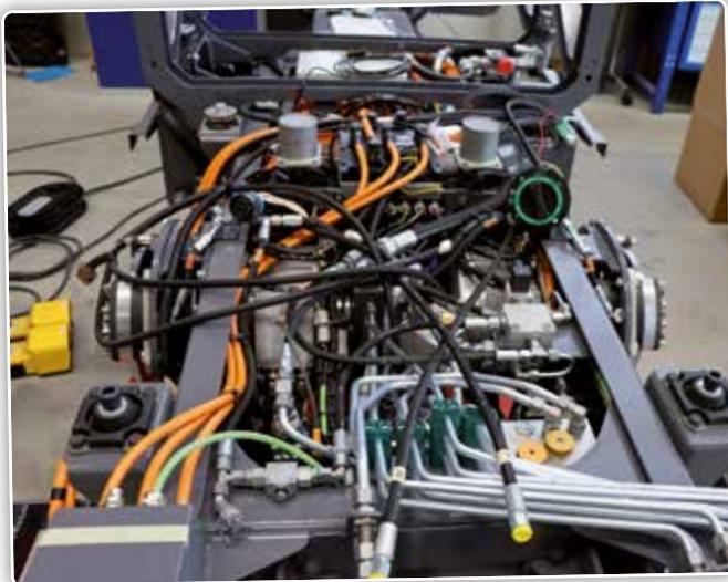
Sur un RECO eTrac équipé au maximum, il y a donc deux moteurs d'avancement et deux unités électro-hydrauliques.
