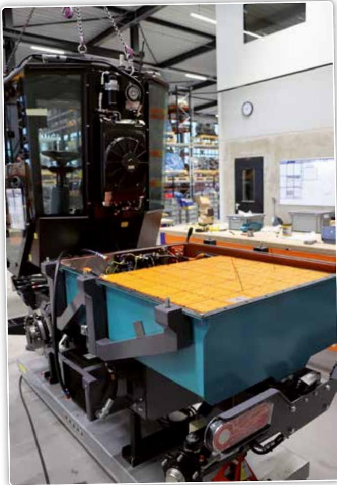
*Si le client opte pour une plate-forme de chargement, un châssis supplémentaire est placé autour de la batterie.*
