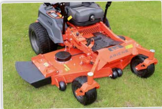
*En option, les clients peuvent opter pour un carter de coupe à éjection latérale ou arrière ou une variante mulch. La hauteur de coupe se règle sur quinze hauteurs différentes à l'aide d'une commande au pied.*
