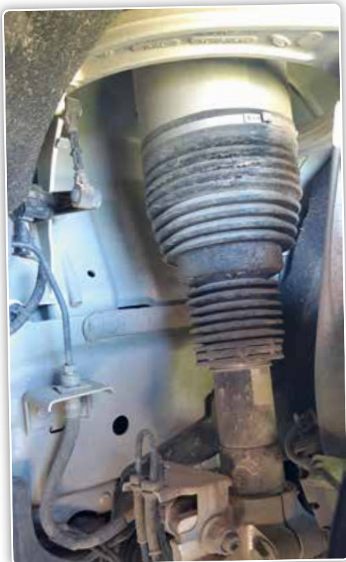
De luchtvering is in de hoogte verstelbaar.
