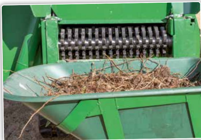
Aan de achterkant van de zandzeefmachine hangt een opvangbak waar de zeefoverloop en dus het afval in terechtkomt. Die kan je heel eenvoudig legen in bijvoorbeeld een kruiwagen en afvoeren.
