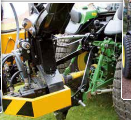
De maaiaarm is voorzien van een degelijke driepuntstabilisatie die men eenvoudig kan uitschakelen door middel van één pen.
