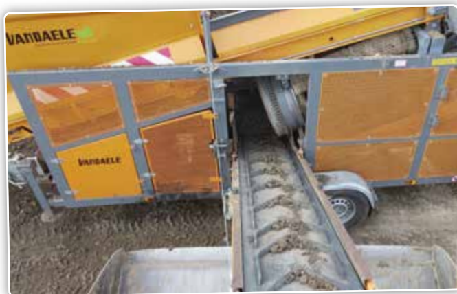
De aan- en afvoer én de vochtigheid van het materiaal bepalen het rendement en de kwaliteit van het zeven.
