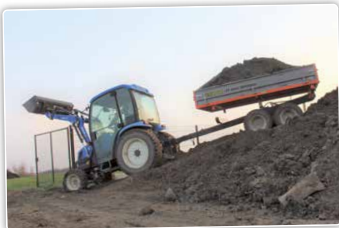
Door de combinatie van een boogjeonderstel en brede banden kan de kipper ook achteruit ver omhoogrijden.
