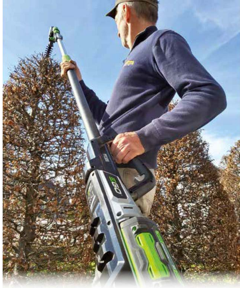
Op de professionele PPX 1000 telescopische aandrijfset kunnen een snoeizaag met een blad van 25 cm en een heggenknipper van 51 cm worden aangekoppeld.
