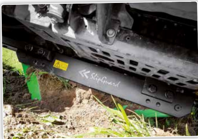
Afhankelijk van de rijrichting boort een van de massieve remkleppen zich als een reddingsanker in de bodem en stopt het voertuig.
