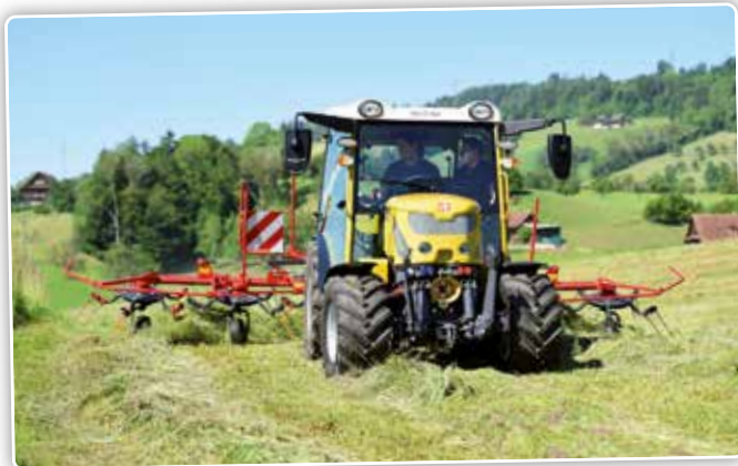
Al is de Rigitrac SKE 40 met 40 kW vooral bedoeld voor hoveniers en groenvoorzieners, ook voor sommige landbouwwerkzaamheden is hij geschikt. Zoals hier bijvoorbeeld voor het schudden van gras/hooi.
