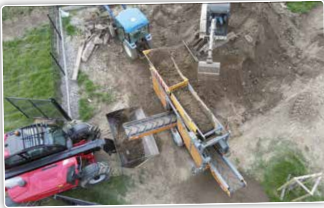
Om het hele zeefproces te overzien werkt het natuurlijk makkelijk om op de hoop te staan en van daaruit te laden.
