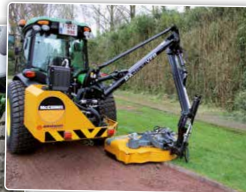
Dankzij het VFR-systeem kan de arm ook naar achter verschuiven zodat hij achter het achterwiel kan maaien en kan dichtplooiën achter het achterwiel tijdens het transport.
