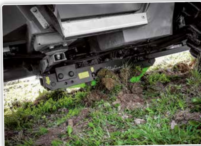
De berging van een voertuig dat met SlipGuard werd afgeremd kan wat werk met zich meebrengen omdat het systeem zich met drek gevuld heeft.
