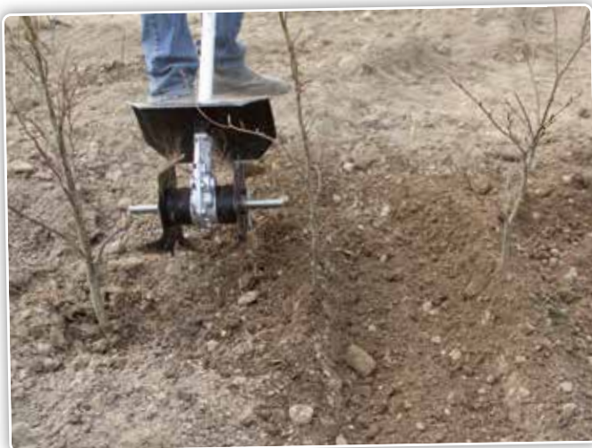
De tuinfrees kan uitgerust worden met 2 of 4 freesmessen die op hun beurt nog eens gedraaid kunnen worden. Dat maakt dat er makkelijk tussen dicht bij elkaar staande haagplanten kan worden geschoffeld zonder de planten te raken.
