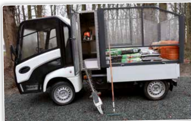
De uitvoering met opgebouwde kippak en opbergruimte voor handgereedschap is een veelgekozen uitvoering bij tuinaannemers en openbare besturen.
