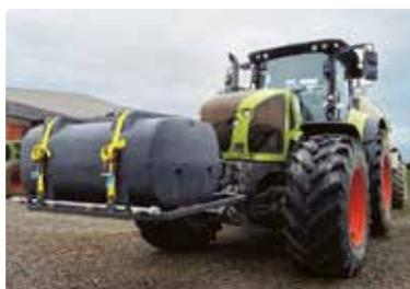
**Le constructeur français Hydrokit a mis au point un système de pulvérisation pour nettoyer les pneus et les roues d'un tracteur ou d'une machine. L'installation pulvérise de l'eau sur les roues du tracteur et des machines ou remorques attelées.**
