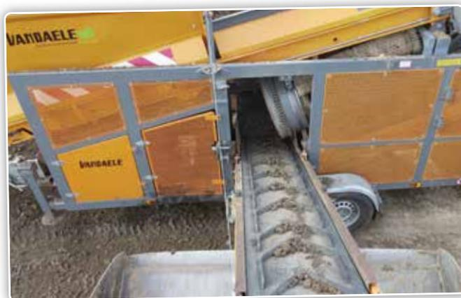
L'approvisionnement et le déchargement de la matière déterminent l'efficacité et la qualité du criblage.
