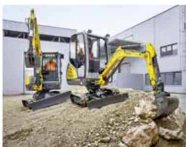
**Wacker Neuson présente un nouveau système de compensation de l'inclinaison sur certains de ses modèles de mini-pelles.**
