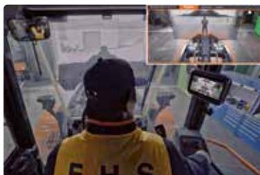
**Doosan Infracore Europe a lancé le premier godet de chargeuse sur roues sur le marché avec un système de sécurité qui rend le godet 'transparent' pour l'opérateur. Cela augmente la sécurité et donne une meilleure vue de la charge.**
