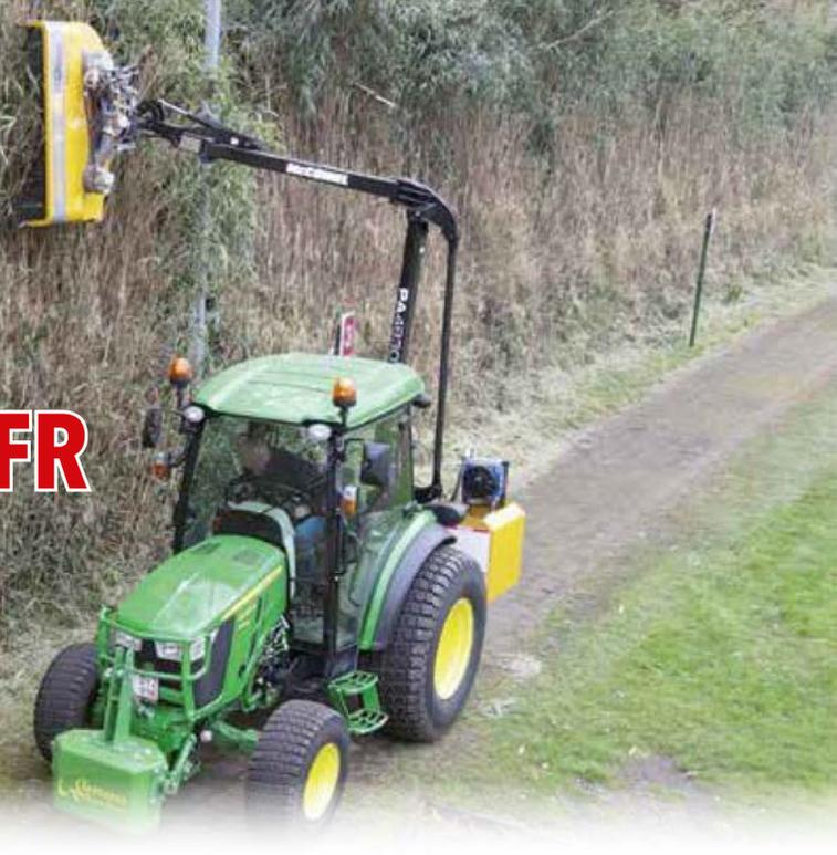
Le constructeur anglais McConnel est l'inventeur du bras de fauche. En plus des modèles bien connus pour les tracteurs agricole, le fabricant propose également une gamme de bras de fauche compacts qui se montent facilement sur des tracteurs compacts afin d'être en mesure d'entretenir efficacement des endroits difficiles d'accès. Ces machines sont importées par la société Dabekausen. Début avril, nous sommes allés voir l'une des premières machines belges à l'œuvre sur un chantier à Westmalle.
