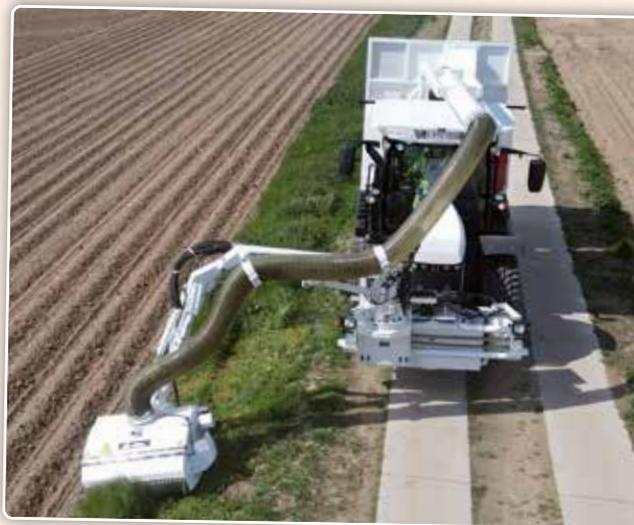
*Le bac de collecte d'une capacité de 8 m<sup>3</sup> est doté d'un tapis d'évacuation, d'une porte arrière et d'une tôle perforée.*
