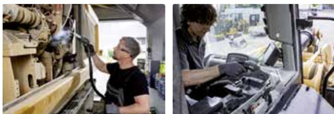
**Le principe du nettoyage à glace sèche est peu connu parce qu'il s'agit d'un processus lourd qui n'est effectué que par des entreprises spécialisées. Cela peut maintenant changer avec le nettoyeur à glace sèche Kärcher, qui fabrique également ses propres pellets de glace.**
