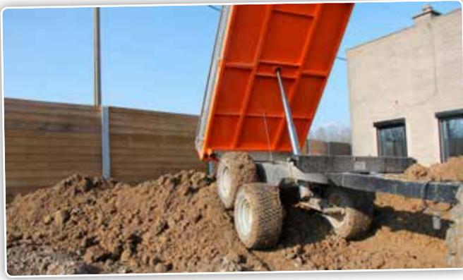
La benne reste très stable au déchargement, même si la charge reste coller à l'avant et que le terrain est inégal.
