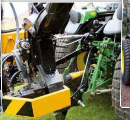
Le bras de fauche est équipé d'un cadre de stabilisation qui est déverrouillé à l'aide d'une broche.
