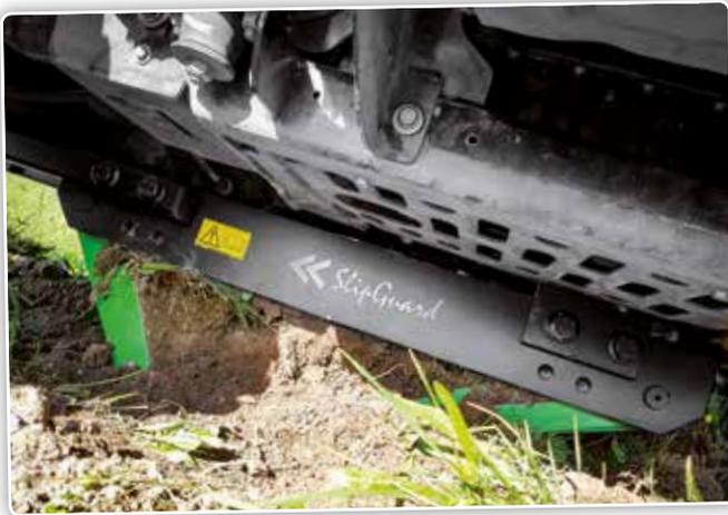
Le système travaille suivant le principe d'une ancre qui s'enfonce dans le sol et va permettre de stopper le véhicule.
