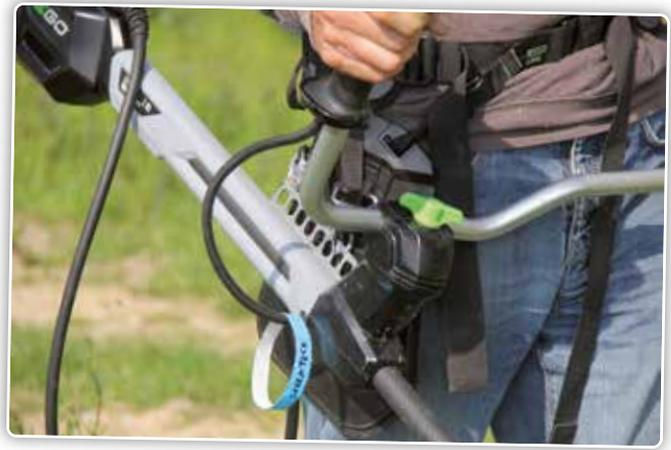
Avec cette débroussailleuse, nous avons opté pour la batterie portée sur le dos, via un harnais. Ce dernier dispose de 4 points de support et se révèle donc confortable.
