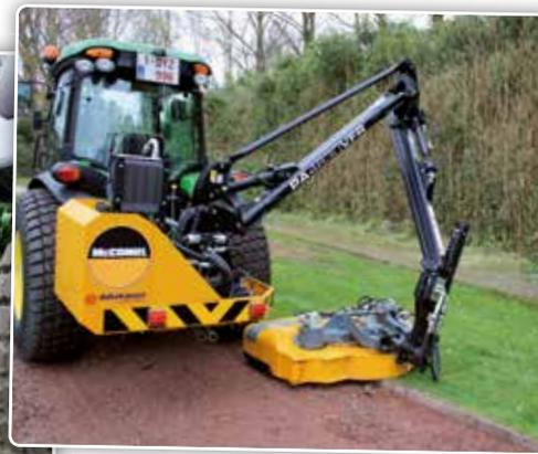
Grâce au système VFR, le bras peut également pivoter vers l'arrière pour faucher derrière la roue arrière du tracteur.
