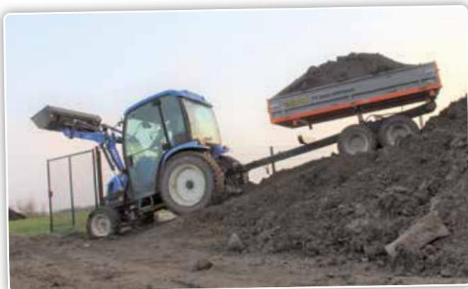
Grâce à la combinaison du boggie et des pneus larges, la benne peut également gravir sans problème une montée en marche arrière.
