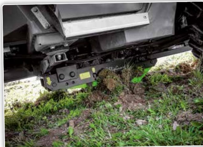
La mise en sécurité d'un véhicule freiné à l'aide d'un Slip Guard peut représenter pas mal de boulot, car le système s'est rempli de boue.
