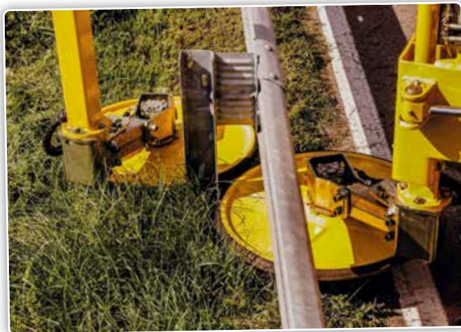
De bovenste schijven zijn met een gummiband omgeven en lopen rond de obstakels of palen van de vangrails.
