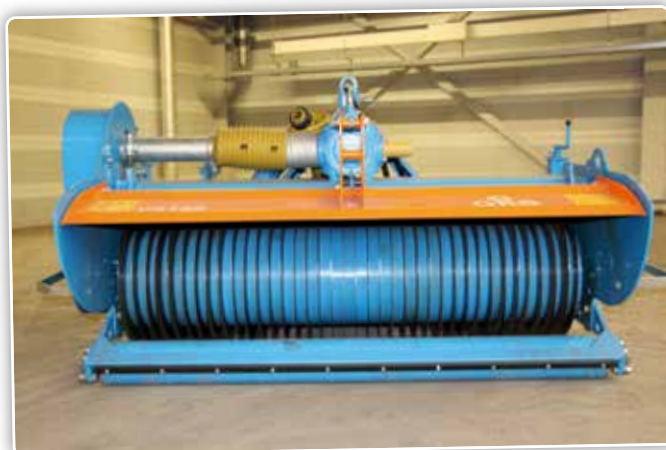
De ingenieurs van GKB hebben een geheel nieuw type snijschijf ontwikkeld met een excentriek erin. De schijven zijn excentrisch met 4 verschillende niveaus, waardoor de snijrotor een andere snijbeweging maakt.
