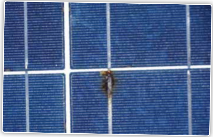
Een 'hotspot' is herkenbaar aan de puntvormige bruine vlekken die door een sterke verhitting ontstaan.
