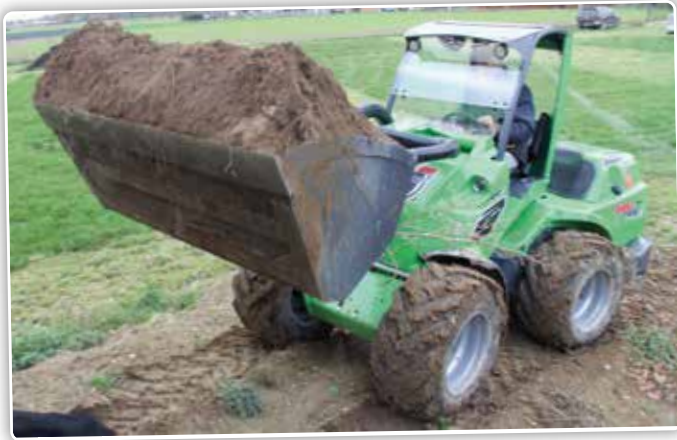
Met een overvol geladen bak blijft de machine stabiel, zelfs in licht geknikte positie tijdens het rijden.
