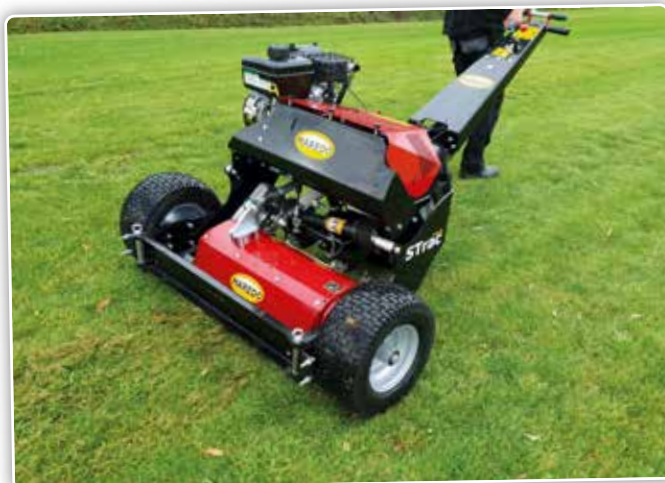
Als de achterwielen achter de machine staan, valt de machine net binnen de 90 cm. Als ze naast de machine staan (zie deze foto) dan is de STrac 700 net 130 centimeter breed en heb je maximale stabiliteit.
