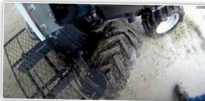
Het Dual-stuursysteem: bij het sturen wordt de knikbesturing bediend, en iets later worden dan de vier wielen afzonderlijk meegeschakeld.
