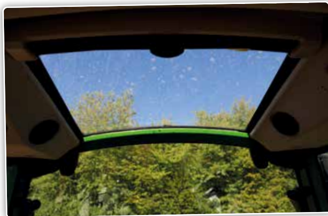
De aangepaste cabine met een verhoogde voorruit en een smallere stijl naar het dakraam zal vooral bij frontladerwerk geapprecieerd worden.
