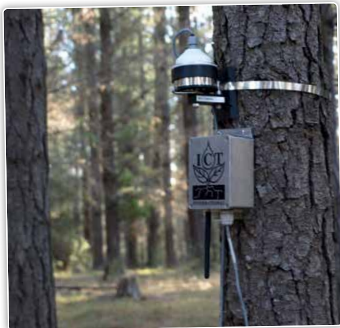
De dendrometer kan veranderingen in de omtrek bij bomen tot op de millimeter nauwkeurig volgen.
