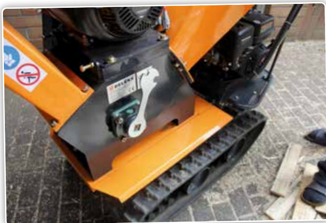
De uitgaande as van de trommel is een vierkante as waarop een sleutel kan worden gezet.
