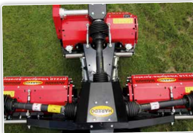
De MT210 is zeer goed bodemvolgend door het flexibel ontworpen hoofdframe en de flexibele ophanging van de MT210-units daaraan.
