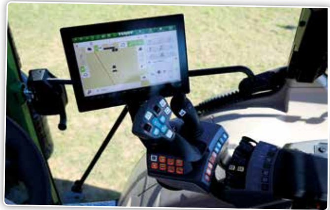
Elementen van FendtONE zijn de nieuwe bedieningsarmsteun, de aangepaste multifunctionele hendel en de (optionele) terminal.
