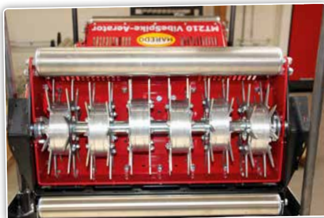
De Maredo MT210 VibeSpike-Aerator heeft vibrerende spikes met een hoogfrequente, uitgebalanceerde trilling.
