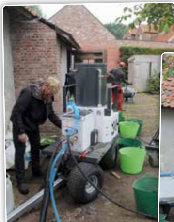
De Drainjet is met zijn 80 cm breedte ideaal om langs smalle doorgangen te passeren.
