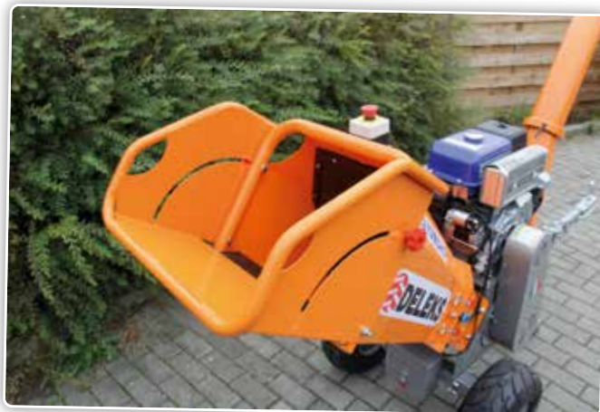
Bij de nieuwe machines is de invoertrechter verlengd. Dat maakt het 'laden' veel makkelijker en dat hebben we gemist op deze versie. Bovendien kan hier de invoertrechter ook snel gedemonteerd worden.
