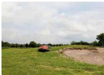
**Husqvarna lance Epos; la tonte par robot avec un fil de bordure virtuel. Le système a été spécialement développé pour les terrains de golf et les terrains de sport. Le terrain de golf Prise d'Eau à Tilburg, aux Pays-Bas, teste cette innovation Husqvarna et, au printemps prochain, elle sera commercialisée pour les utilisateurs professionnels.**
