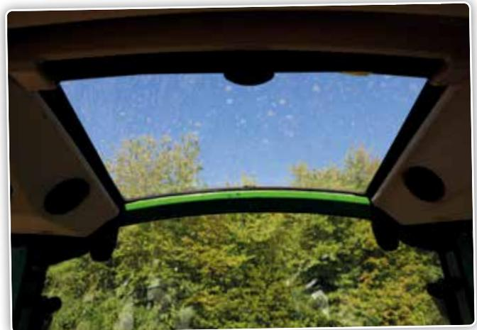
La cabine adaptée avec pare-brise avant plus haut et des montants plus étroits sera principalement appréciée pour les travaux au chargeur frontal.
