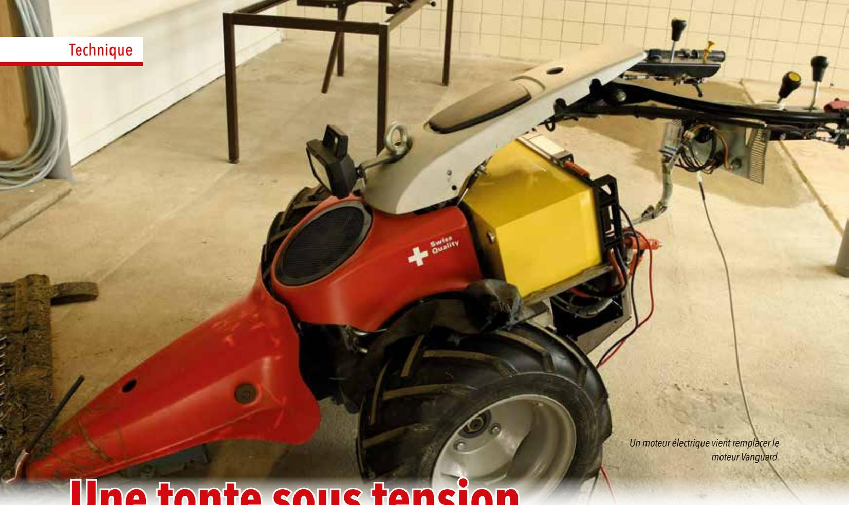
Un moteur électrique vient remplacer le moteur Vanguard.
