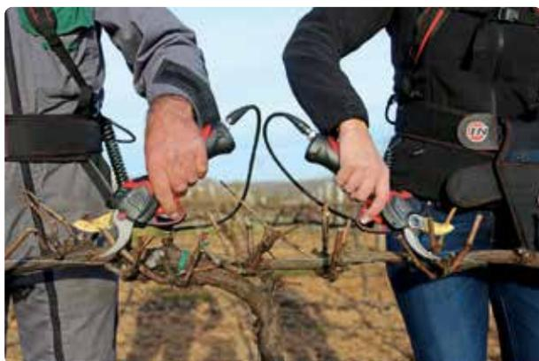
**Le système sans fil DSES est une nouvelle protection de coupe pour les sécateurs électriques qui est activé immédiatement au contact de la peau ou d'un gant conducteur. Ce système fonctionne sans fil et protège l'utilisateur contre les coupures. Ce système sans fil a été inventé et breveté par Infaco et ses partenaires.**
