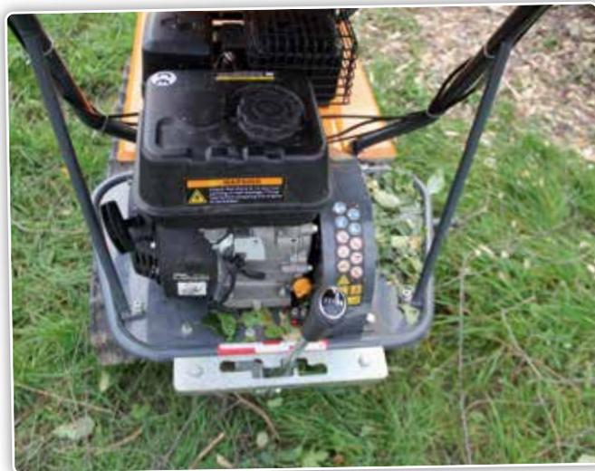
*Pour avancer, il suffit de démarrer le moteur d'avancement, de mettre la transmission en vitesse et de déverrouiller le levier de sécurité à gauche.*
