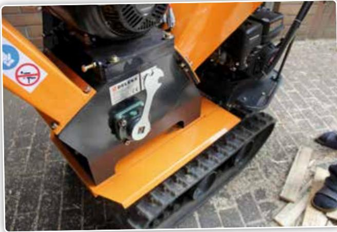
L'axe sortant du disque est un axe carré sur lequel une clé peut être fixée.
