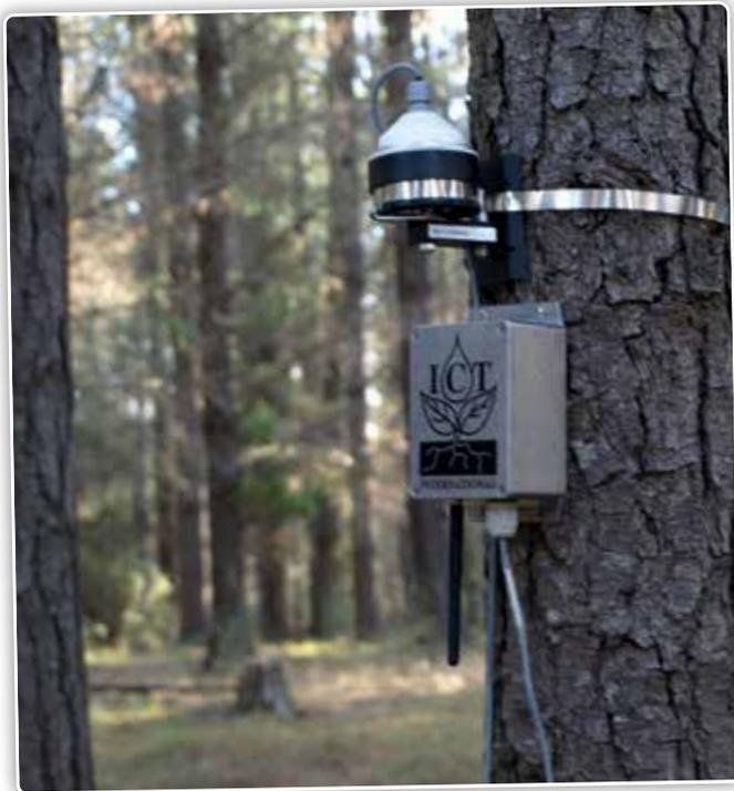
*Le dendromètre permet de suivre avec précision des changements de circonférence des troncs, au millimètre près.*
