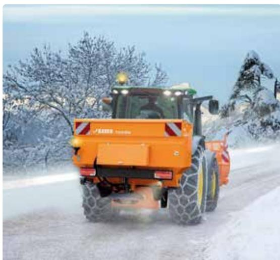
**L'épandeur de sel porté trois points Rauch Taxon 25.1 est entraîné via l'hydraulique du tracteur et géré via un terminal embarqué.**
