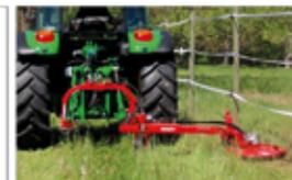
**Débroussaillieuses sous clôtures** • Ø 0,5 à 0,8 m
