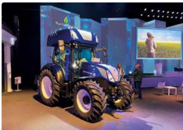
**La société néerlandaise Jos Scholman est la première entreprise au monde à exploiter un tracteur partiellement alimenté à l'hydrogène. En collaboration avec Blue Fuel Solutions, New Holland a créé un ensemble de construction qui permet au tracteur de fonctionner sur un mélange de diesel et d'hydrogène. Il en résulte - selon le type de travail - une réduction de 50 % du CO<sub>2</sub>.**
