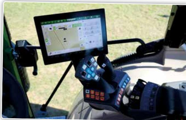
Les éléments du FendtOne sont le nouvel accoudoir de commande, le joystick multifonctionnel adapté et le terminal optionnel.
