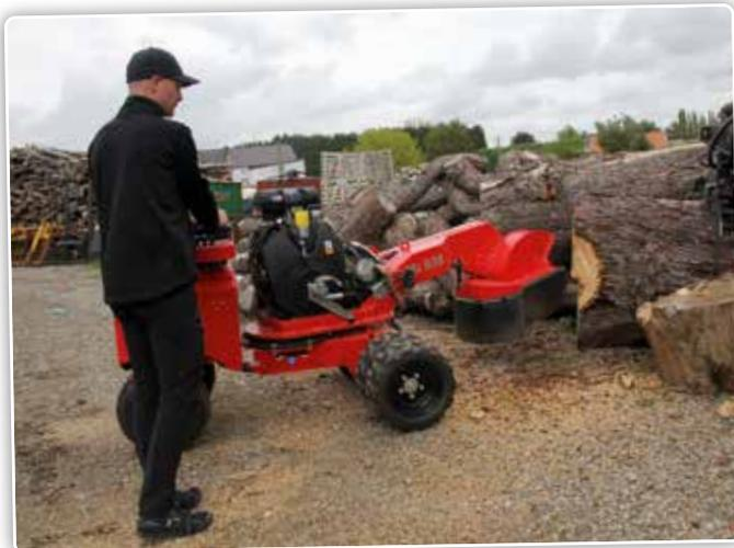
l'avant afin de renforcer la stabilité. Sans ces roues, sa largeur est de 79 cm. La portée de la tête de fraisage est de 170 cm, et la tête fait des allers-retours automatiques. La vitesse de ces mouvements peut être réglée. Les 12 couteaux de la tête de fraisage peuvent être utilisés sous 3 angles différents. Le panneau de commande peut quant à lui pivoter sur 90 degrés.
