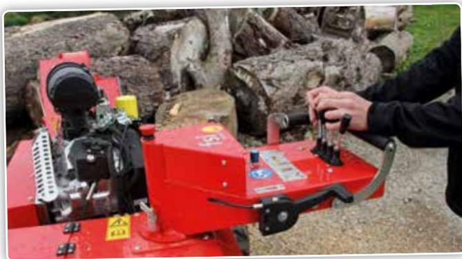
Cette machine mesure 2,83 m de long pour une largeur de 0,79 m et une hauteur de 1,26 m. L'ensemble pèse 840 kg.
