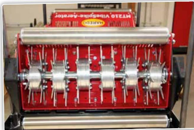
Le Maredo MT210 VibeSpike-Aerator est doté de spikes vibrants à vibration haute fréquence.
