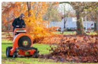
**Un phénomène typiquement américain est la machine stand-on, un automoteur où le conducteur est à l'arrière de la machine. Nous les voyons habituellement dans l'exécution d'une tondeuse à gazon, mais Billy Goat les propose aussi en version avec un souffleur de feuilles.**
