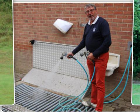
La durabilité s'exprime aussi dans les petits détails, comme ce tuyau d'eau équipé d'un jet d'air comprimé afin de limiter la consommation d'eau.
