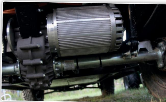
Un moteur électrique triphasé de 10 kW assure les besoins en traction.
