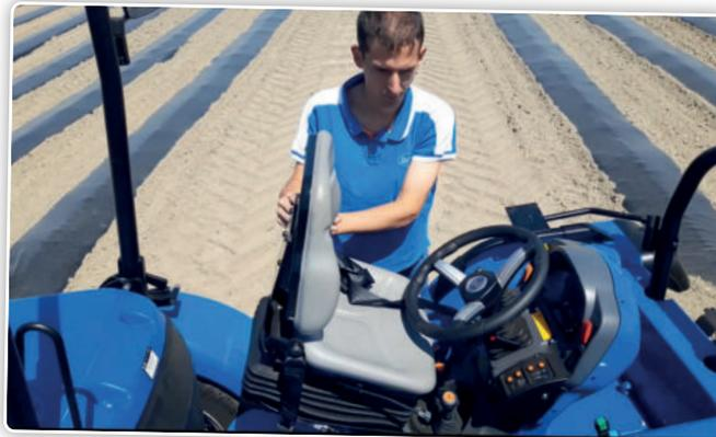
Le poste inversé: déverrouiller, replier le siège vers l'avant, et tourner ensuite le plateau avec le volant et le siège de 180°. Les leviers de vitesse restent en place.
