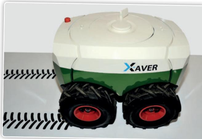
Les robots de champ à entraînement électrique monoroue Xaver de Fendt fonctionneraient dans un 'essaim' au champ. Une condition préalable à ces technologies est un réseau mobile 5G rapide.
