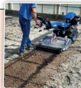
Le système PDC est basé sur un rouleau de rappui qui permet de maintenir une profondeur de travail constante.
