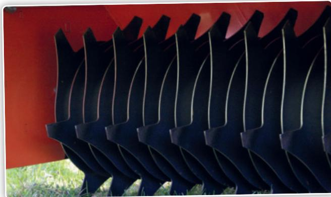
En raison de la position des lames les unes par rapport aux autres, la pointe d'une lame ne s'enfonce que lorsque la lame située à côté sort du sol. En conséquence, même un gazon moins bien enraciné n'est pas déstructuré et le rotor tourne avec beaucoup moins d'à-coups.
