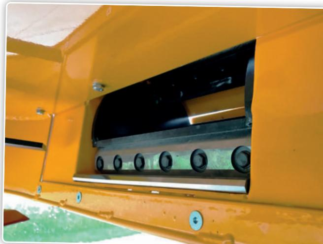
Un broyeur est monté derrière le taille-haies afin de réduire le volume des déchets.
