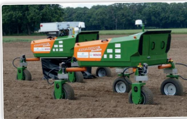
*Un exemple est le projet EU Flourish dans lequel un drone pour identifier les tâches d'adventices est lié à un robot de terrain qui effectue indépendamment le travail de terrain nécessaire. De tels systèmes feront à l'avenir partie d'un 'Edge Cloud' temporaire.*
