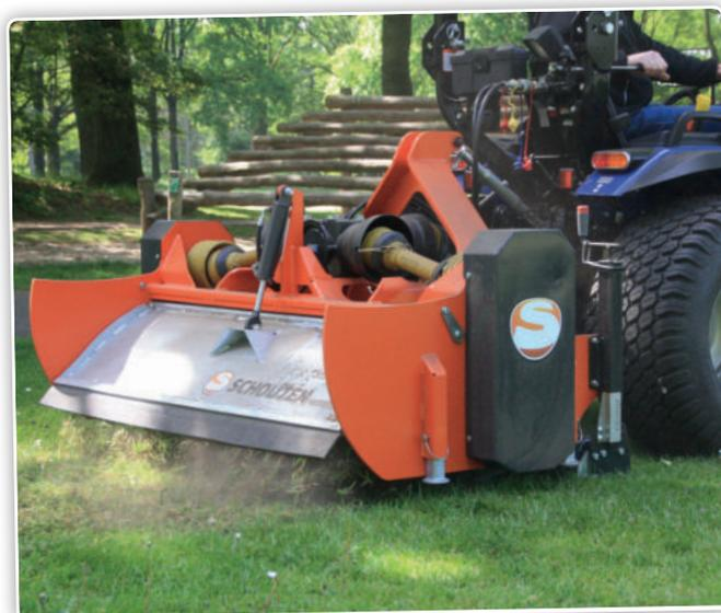
Le Rabbit est disponible en largeurs de travail de 150 et 230 cm. Pour la première machine, un tracteur d'une puissance de 30 ch suffit.
