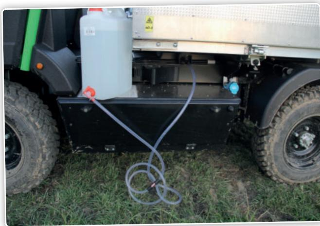
La batterie est chargée en l'espace de 8 heures. L'autonomie est de 100 km, en fonction de l'utilisation. Lors de la charge, une faible quantité d'eau est également ajoutée afin d'allonger la durée de vie de la batterie.
