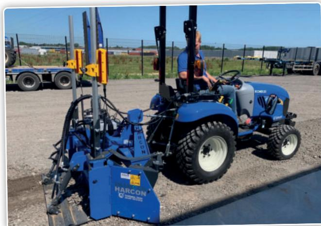
Avec deux récepteurs, la machine est guidée à gauche et à droite. Cela permet d'assurer une précision au millimètre.
