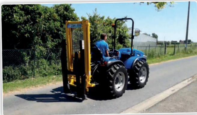
Lors des déplacements sur route avec le Volcan, l'empattement plus long offre davantage de stabilité et de confort de roulage. Pour un tracteur qui atteint une vitesse de pointe de 40 km/h, c'est un atout.
