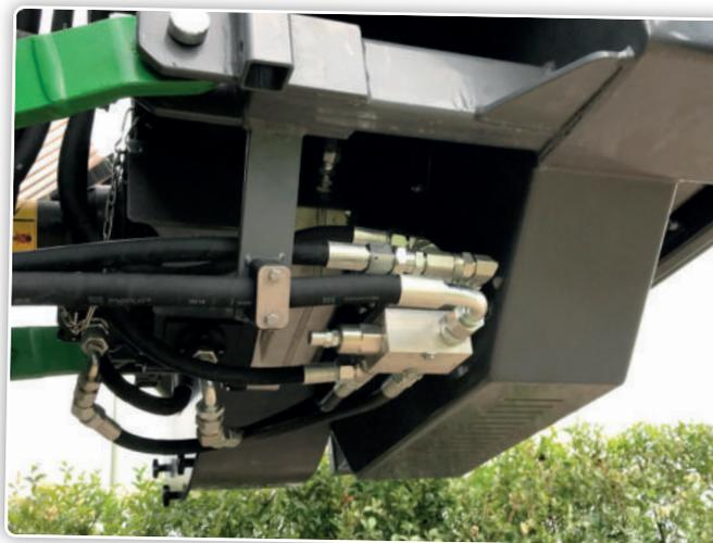
Les flexibles hydrauliques sont tous pourvus de raccords rapides et les tuyaux hydrauliques passent au centre, sous le tracteur.
