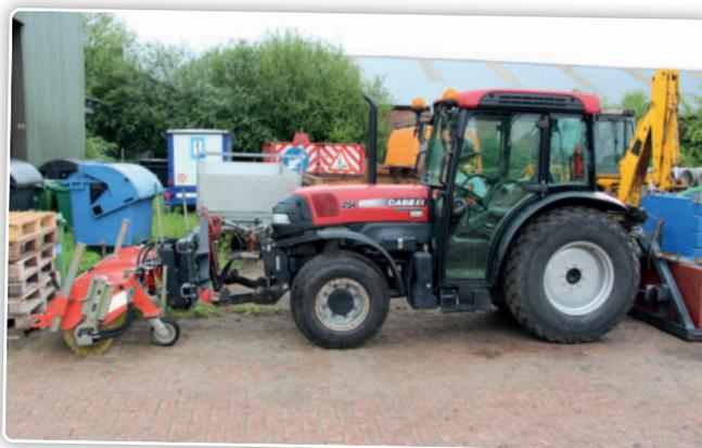
*De plus, la commune possède un tracteur Case IH Quantum 75F avec brosse à balayage qui est utilisé de façon multifonctionnelle. La brosse de balayage est utilisée en été pour balayer les bordures, les sentiers pédestres, les pistes cyclables et les côtés de la rue, en automne pour balayer les feuilles de même que pour le service hivernal.*
