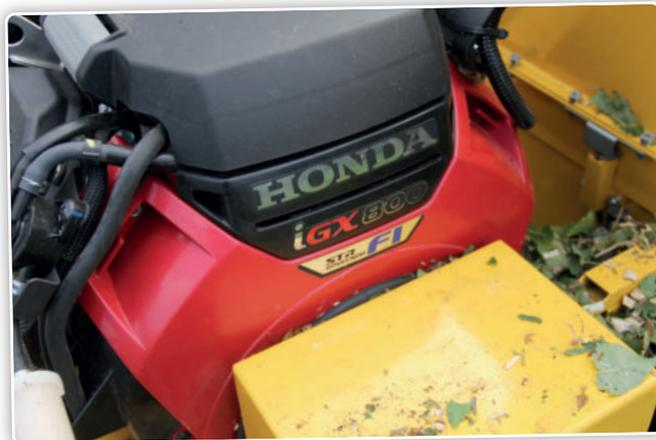
Le changement le plus radical pour le M500 est le moteur 'Next Generation'. Ce broyeur professionnel est équipé d'un moteur Honda iGX800 d'une puissance de 25 ch.
