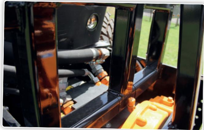
Les pompes hydrauliques pour le bras sont montées à l'avant du tracteur.
