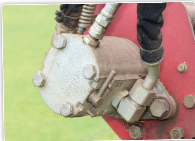
Les moteurs montés sur les éléments de coupe sont une particularité. Ils peuvent être mis au neutre, ce qui permet de nettoyer et régler l'unité de coupe sans contre-pression.
