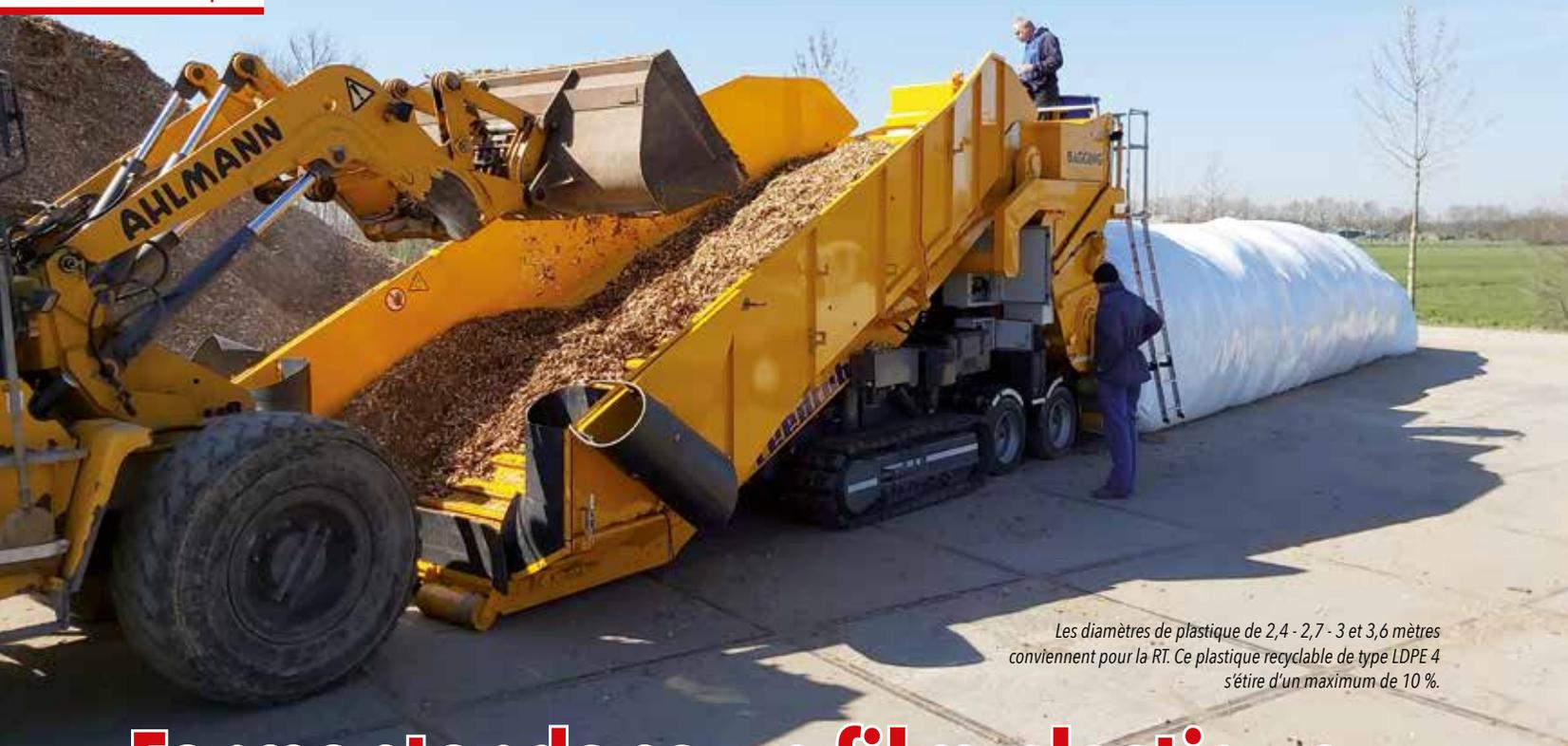
Les diamètres de plastique de 2,4 - 2,7 - 3 et 3,6 mètres conviennent pour la RT. Ce plastique recyclable de type LDPE 4 s'étire d'un maximum de 10 %.
