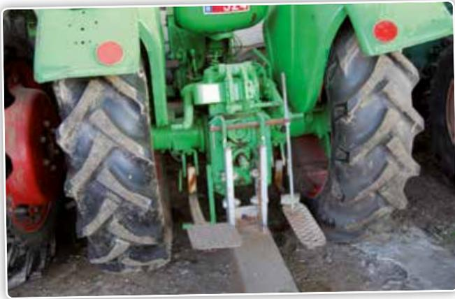
Un oldtimer équipé d'un embrayage et de freins mécaniques à l'arrière.
