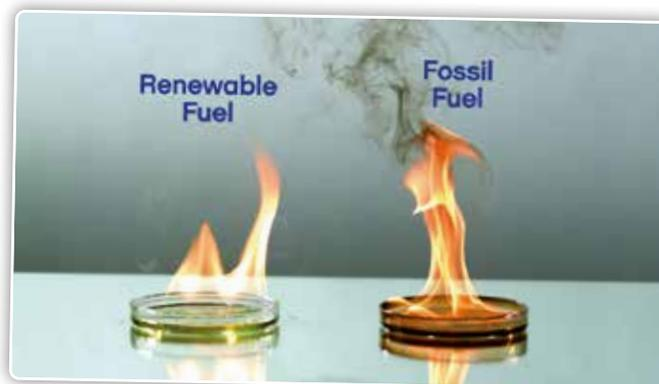
A gauche, la combustion de HVO ou diesel bleu, à droite celle de diesel classique.
