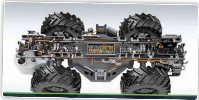
L'ensemble de batteries développe une puissance maximale de 75 kW (102 ch) et fonctionne en 700 volts.
