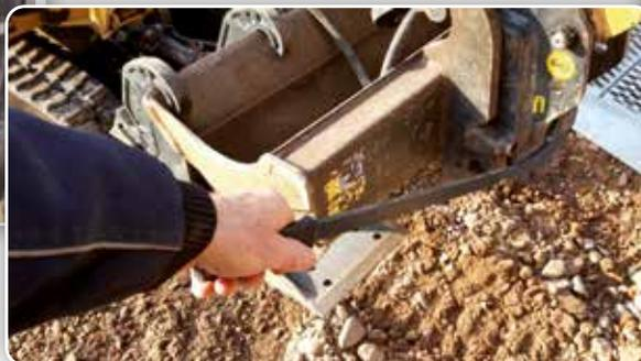
Le système de changement rapide des accessoires est commandé à l'aide d'une clé spéciale.
