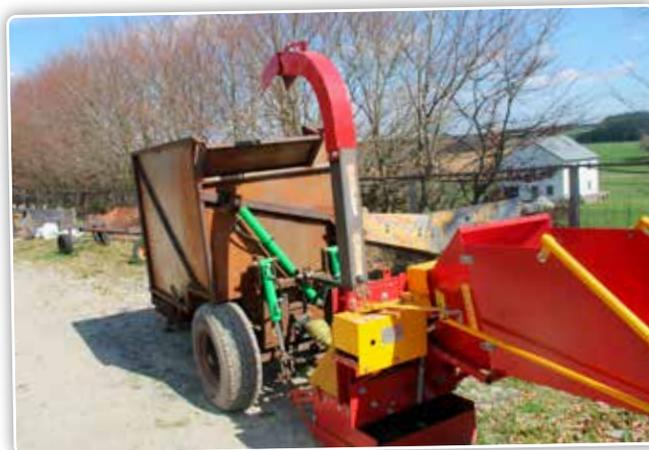
Cette remorque tribenne avec relevage et prise de force arrière permet d'entraîner un broyeur lourd derrière un tracteur léger tout en collectant la matière broyée sur place. Le but est de compléter ce concept par une remorque transbordeuse afin de pouvoir décharger la matière collectée suffisamment haut.
