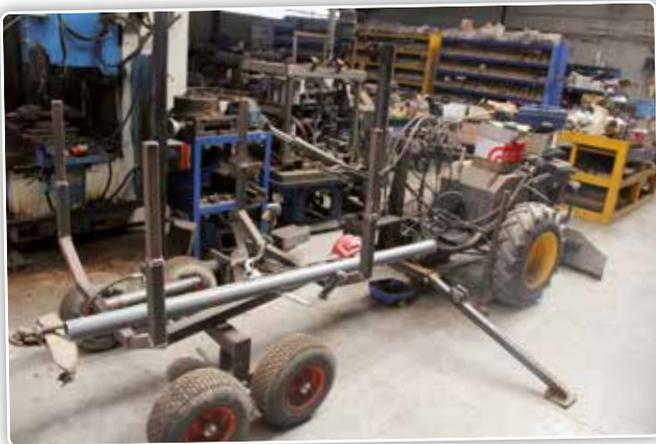
Concept d'une remorque à bois qui peut évoluer dans deux directions. A l'avant, on retrouve une lame afin de dégager le chemin dans la forêt. La plate-forme destinée au chargement du bois peut être désaccouplée, permettant ainsi au véhicule tracteur d'être accouplé à une benne, par exemple.
