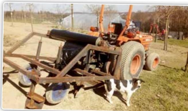
Une machine pour poser un film plastique. Les roues peuvent être disposées dans toutes les directions pour serrer plus ou moins le film plastique. Les socs latéraux servent à fixer le film dans la terre.
