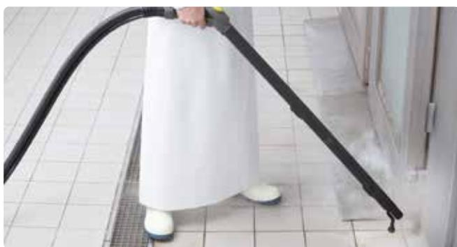
**Lors du nettoyage des surfaces polluées, nous pensons principalement aux nettoyeurs à haute pression en combinaison ou non avec des détergents. Il faut alors pouvoir être en mesure de recycler les eaux usées, y compris les détergents, et de travailler à une température moyenne de 60°C.**
