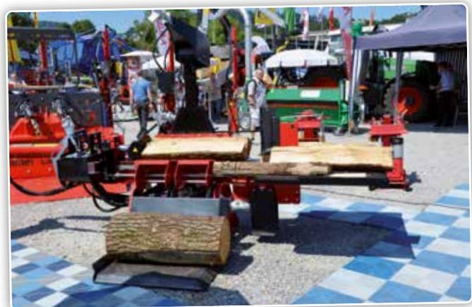
*Un relevage permet de faciliter l'alimentation en bois sur une fendeuse horizontale.*
