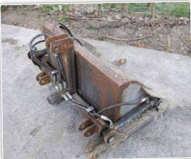
Un bac surdimensionné qui peut être incliné hydrauliquement à l'aide de deux vérins latéraux, et qui peut travailler de façon plus ou moins agressive grâce à un vérin dans le troisième point.
