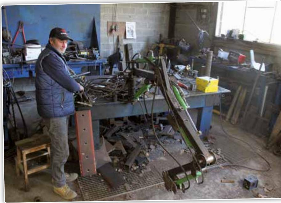
Jan Noordam près d'un bras de fauche qui peut être équipé d'un broyeur à fléaux, d'un taille-haies ou d'une brosse rotative. Le bras est fixé à l'établi pendant le montage et peut être entièrement actionné. Si nécessaire, quelque chose peut toujours être adapté comme avec un meccano. L'extrémité du bras peut également être tournée de sorte qu'il est possible de travailler derrière un poteau ou un obstacle.
