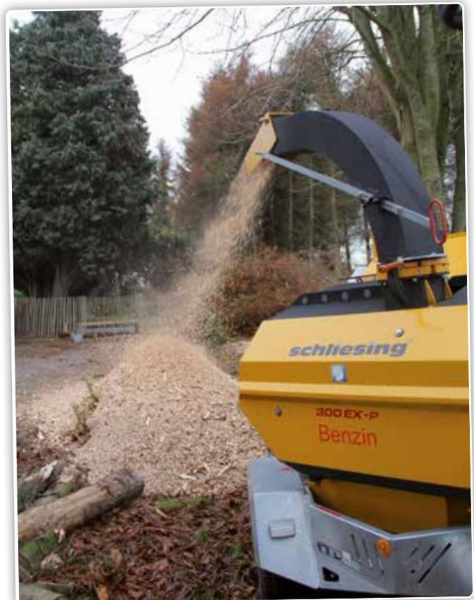
Le bois déchiqueté à un diamètre maximum de 5 mm et une longueur de 25 mm.
