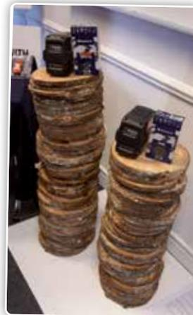
La pile de droite est le nombre de disques coupés avec l'ancien modèle de chaîne et avec une charge de batterie. La pile de gauche est celle réalisée avec le nouveau modèle de chaîne.
