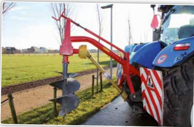
En octobre 2019, la ville a aussi investi dans une tarière pour réaliser des trous de plantation d'un diamètre maximal de 100 cm.
