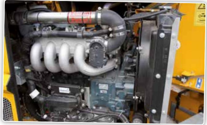
Le 300 EX P est équipé d'un moteur essence Kubota 4 cylindres à catalyseur et refroidissement par eau d'une puissance de 57,8 ch.
