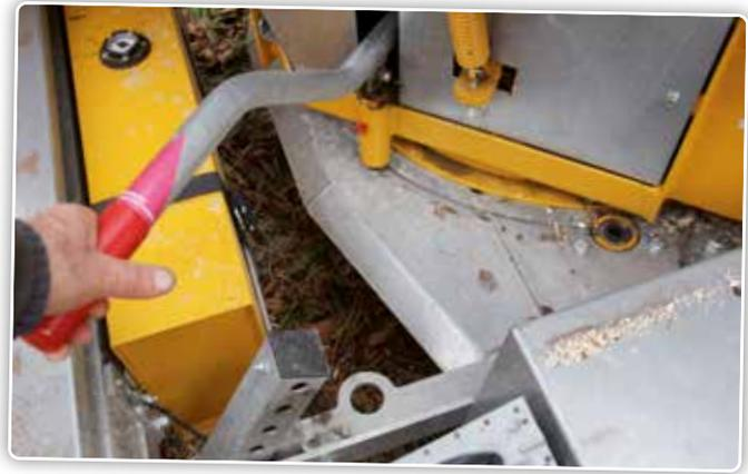
La machine pivote de 270 degrés sur son plateau, ce qui vous permet de toujours placer l'ouverture d'alimentation dans la bonne direction du flux de matière à broyer.
