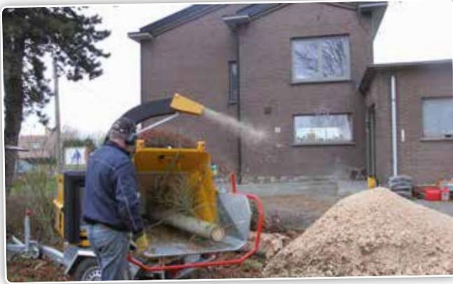
Même en broyant du bois d'un diamètre de 19 cm, le moteur ne flanche pas.
