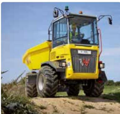
Wacker Neuson introduit le concept Dual View pour ses dumpers sur roues avec une charge utile de six à dix tonnes. Avec ce concept, l'ensemble de la console de commande et de siège peut être tourné rapidement et facilement sur 180 degrés.
