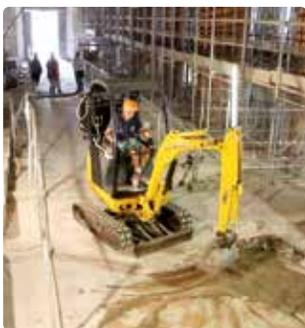
L'italien ZainoMotore propose un ensemble de conversion qui permet de convertir facilement des mini-pelles de toutes les marques et d'un poids de 1,1 à 2 tonnes en une machine hybride.
