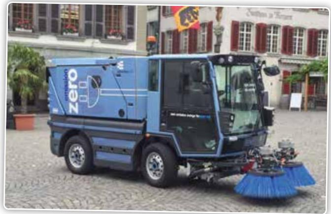
Aebi Schmidt a équipé une balayeuse existante de batteries lithium-ion.
