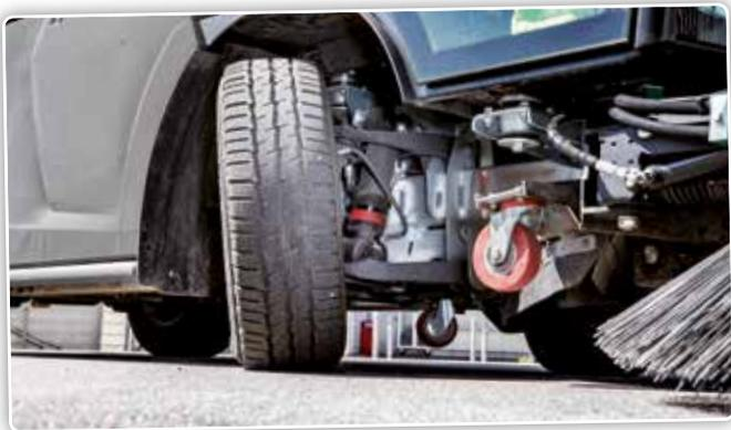
A l'avant, la machine est dotée d'une suspension à trois points et stabilisateurs hydrauliques de type Mc Pherson.
