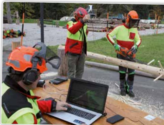
Les modèles à essence et sur batteries ont été testés par plusieurs personnes et dans des conditions comparables.
