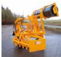
Le constructeur écossais Murray Machinery présente son nouveau Gravel Road Grader avec rouleau compacteur pour l'entretien des chemins en gravier.
