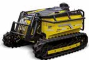
Le RoboMini d'Energreen est un porte-outils compact à commande radiographique. Il a été développé pour travailler sur des pentes allant jusqu'à 50° et permet de travailler en toute sécurité dans toutes les directions.
