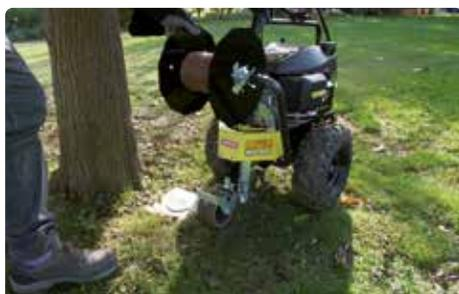
**Wiper présente une nouvelle machine pour la pose des câbles de délimitation du rayon d'action des tondeuses robot. Cette machine permet d'enfouir deux câbles simultanément dans la tranchée qui vient d'être formée.**
