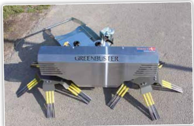
Le Greenbuster dispose d'un rendement théorique de 3.300 m<sup>2</sup> par heure.
