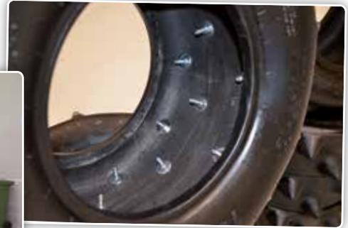
Ces pointes sont vissées à travers le pneu et sont soutenues par un renfort du côté intérieur.
