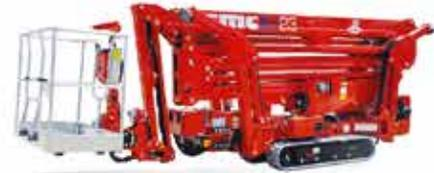
D'une largeur de 88 cm et d'une hauteur de 198 cm, cette plate-forme CMC de faible poids, très compacte, ayant deux sources d'alimentation (moteur thermique et électrique) passe dans une porte standard
