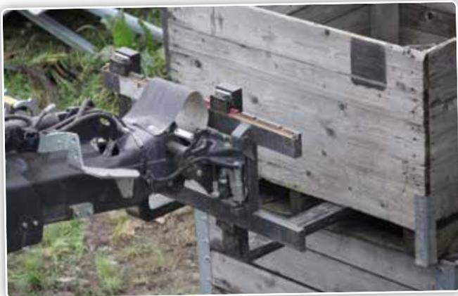
Vue sur le bras de levage télescopique et le dispositif hydraulique de changement rapide des outils.
