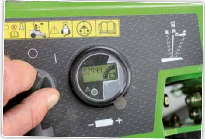
La charge restante de la batterie peut être lue sur le tableau de bord ou sur les batteries. Les Majoris CXR sont entraînées par des batteries Green Lithium Energy Modules d'un total de 420 ampères à 48 volts.
