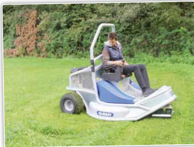
La RM120 allie le confort d'une tondeuse zéro turn à la facilité de conduite par joystick.
