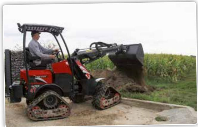
Le godet de ce Norcar dispose d'un angle de bennage important.
