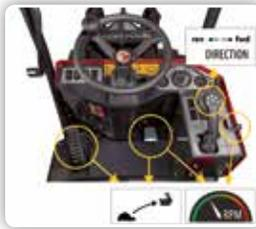
Ce chargeur articulé a7545 4T est équipé d'un système d'avancement de type automotive. Ce système permet à l'opérateur de contrôler entièrement le régime moteur et la transmission lors des inversions de sens d'avancement. Ce dernier est choisi via un bouton sur le joystick. Sur ce système d'avancement automotive, le régime du
