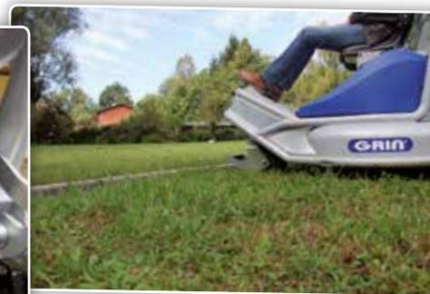
Le carter de coupe forme un ensemble avec le châssis de la machine. L'essieu arrière et la double roue avant sont reliés entre eux et avec le châssis par un parallélogramme. Un vérin hydraulique permet de régler la hauteur de coupe.
