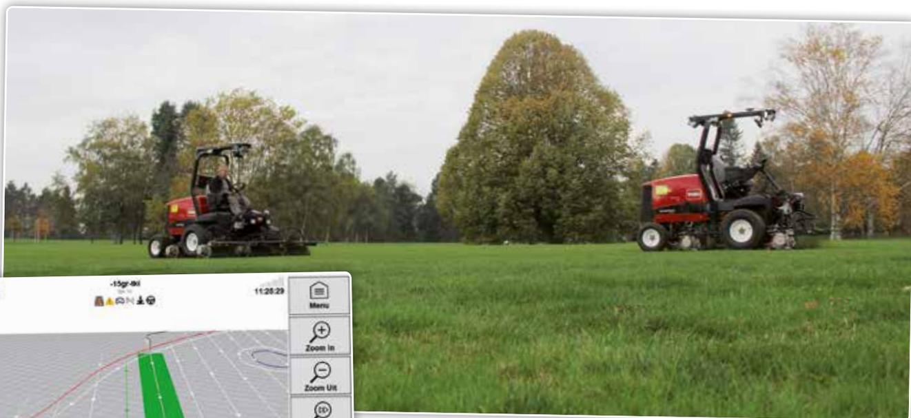
*Le but est de tondre les fairways à l'aide de 2 machines autonomes et d'une machine classique avec un opérateur.*
