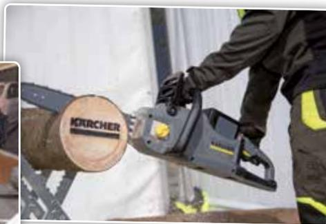
Avec une batterie entièrement chargée, cette tronçonneuse permettrait de scier 100 fois une branche d'un diamètre de 10 cm.
