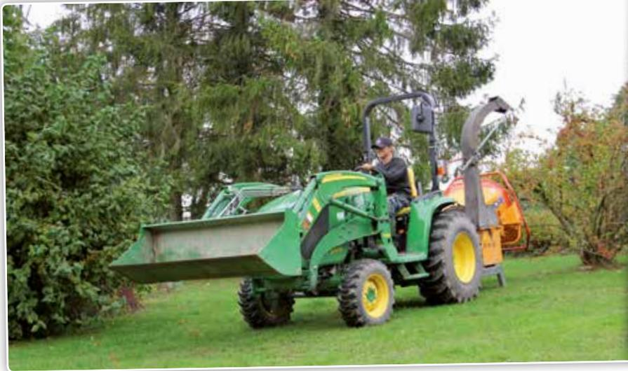
Le tracteur compact John Deere 3045R est muni d'un chargeur qui lui permet de lever 700kg.
