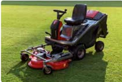
Le constructeur italien Gianni Ferrari présente ses premières tondeuses à siège sur batteries, les GSR+ Electric et GTM+ Electric. Le modèle GSR+ est équipé d'un carter de coupe frontal de 112 cm avec éjection arrière ou mulcheur, tandis que le modèle GTM+ est équipé d'un carter de coupe de 80 cm placé au centre de la machine et qui permet de mulcher ou d'éjecter l'herbe à l'arrière.
