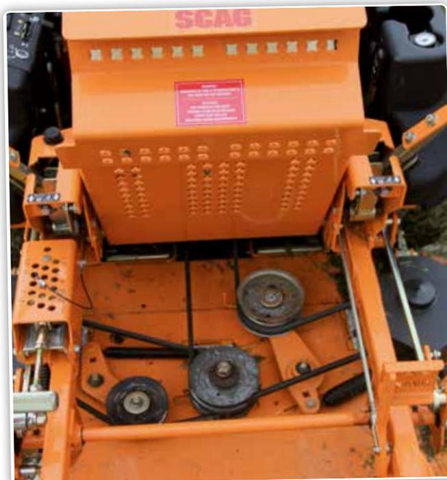
Il suffit de relever une tôle vers l'arrière pour accéder aux courroies des éléments de tonte.
