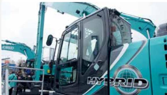
**Kobelco est le premier constructeur qui utilise une batterie lithium-ion dans une grande pelleteuse.**
