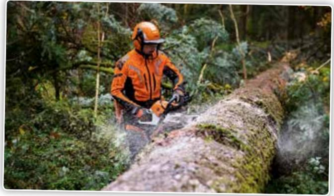
*Comme l'électronique adapte en permanence la quantité injectée, la tronçonneuse ne baisse quasi pas de régime, même lorsqu'on travaille en continu.*
