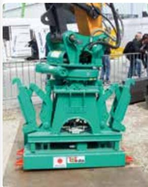
**Ueda, une entreprise qui construit de nombreux accessoires pour les pelleteuses, a développé un aimant qui permet de poser facilement et en toute sécurité des plaques de roulage.**
