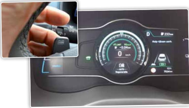
Le levier au volant permet de régler l'intensité de freinage et donc également celle de régénération.
