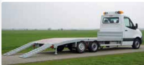
**Veldhuizen a transformé un Mercedes Sprinter en y ajoutant un châssis surbaissé. Dans cette configuration, la hauteur d'accès n'est que de 52 centimètres.**
