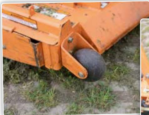
Afin de garantir la rigidité du châssis du carter de coupe, Scag recourt à de l'acier d'une épaisseur allant jusqu'à 1,2 cm à certains endroits.
