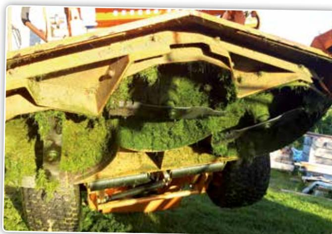
Le carter de coupe d'une largeur de travail de 132 cm avec lequel nous avons roulé dispose de 3 couteaux. Chaque couteau est doté de 2 roulements coniques.
