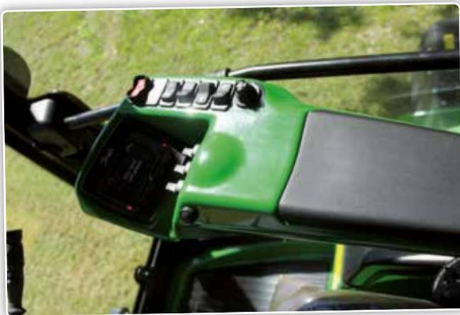
Le modèle F5 bénéficie d'un ordinateur de bord monté sur l'accoudeur et qui permet d'afficher digitalement toutes les fonctions de contrôle.
