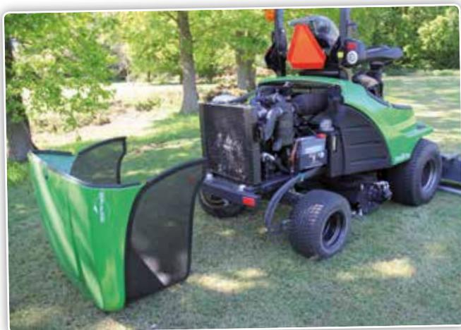
Pour les opérations de maintenance, le capot moteur de la F3 peut être démonté rapidement et entièrement par une seule personne.
