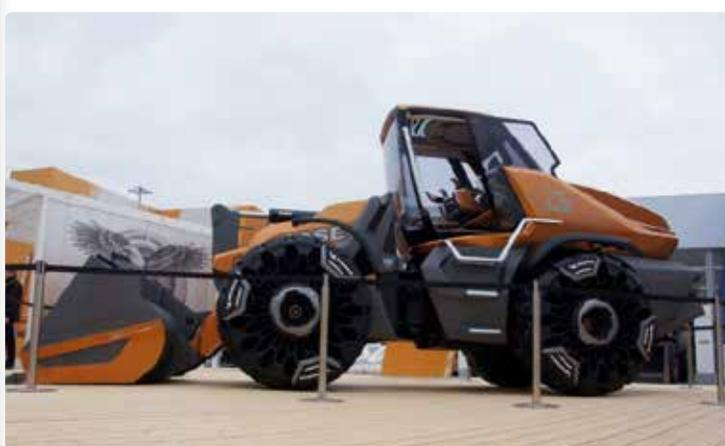
La présentation de ce prototype de chargeur sur pneus Case attire surtout l'attention de par ses formes futuristes. Beaucoup plus important cependant: le constructeur a opté pour le méthane en tant que carburant. La technique et le réservoir approprié se trouvent sous le capot moteur.
