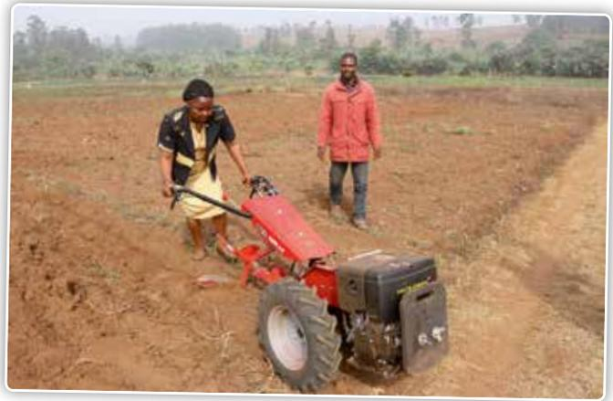
*Köpl construit aussi des accessoires plus exotiques. Il y a quelques années, le distributeur camerounais avait ainsi par exemple commandé un motoculteur à commande manuelle pour la culture de pommes de terre.*
