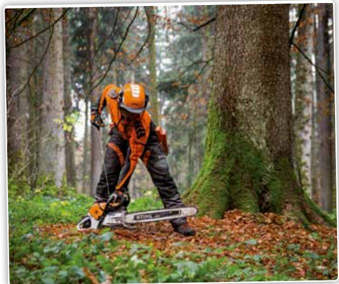
*La 500i n'a pas de choke. Avant de démarrer à froid, il faut donc pomper du carburant à l'aide d'un bouton-poussoir. Stihl l'appelle le bouton de purge: il faut l'enfoncer entre 5 et 8 fois et le moteur démarre alors lorsqu'on tire deux fois sur la corde.*
