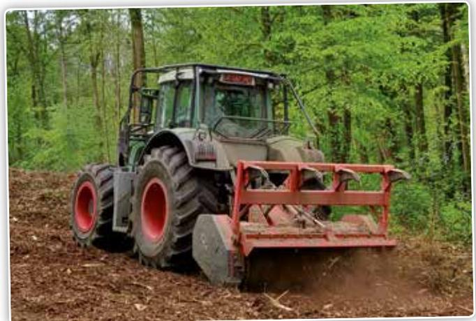
*Le Fendt le plus puissant est presque quasiment utilisé en combinaison avec un broyeur forestier.*
