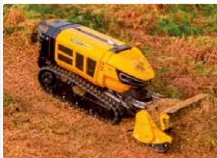
La société Dabekausen présente les broyeurs à fléaux à commande à distance McConnell Robocut RC56 et RC75 qui sont, d'après la firme, les modèles les plus récents et les plus puissants qui existent. Quelques caractéristiques importantes sont des moteurs plus puissants, un système révolutionnaire de contrôle de la sécurité, un guidage plus efficace par gps, une meilleure construction et un design entièrement redessiné.
