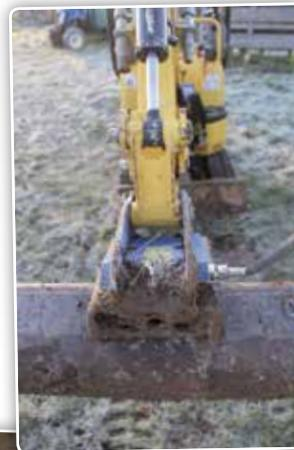
Le système de changement rapide permet de gagner du temps. Il suffit en effet de déverrouiller l'accessoire, de changer de bac et on est reparti.
