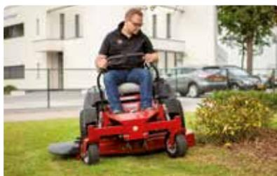
Ferris présente la 400S, une tondeuse zéro turn pour un usage semi-professionnel. Les atouts de cette tondeuse, comme la suspension indépendante sur les 4 roues, la robuste transmission Hydro-Gear ou encore le moteur essence B&S d'une puissance de 23 ch autorisent une vitesse de travail allant jusqu'à 13 km/h.
