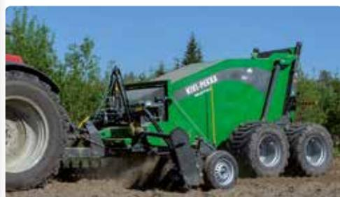
**La ramasseuse de pierres Kivi-Pekka 7 travaille sur une largeur de 7 mètres et est de ce fait une machine imposante. Elle permet de collecter 1.400 kg de pierres par minute et de les charger ensuite dans le bac de collecte de 3 m<sup>3</sup>.**
