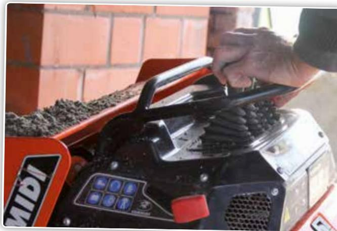
Les leviers de commande sont bien regroupés au centre de la console de commande et peuvent se commander à l'aide d'une seule main.
