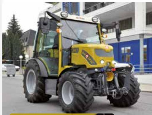
**Le constructeur suisse de tracteurs Rigitrac a développé le modèle Rigitrac SKE 50 à entraînement entièrement électrique. Il s'agit d'un tracteur compact pour le secteur des espaces verts. Ce tracteur sera testé pour la première fois dans la pratique au cours du printemps. Il dispose d'une puissance de 68 ch et est équipé d'une batterie lithium-ion de 80 kWh.**
