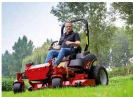
Ferris présente la tondeuse zéro turn ISX 800Z pour les utilisateurs professionnels. Cette tondeuse d'une largeur de travail de 132 cm est entraînée par un moteur B&S de 27 ch et d'une cylindrée de 810 cc.
