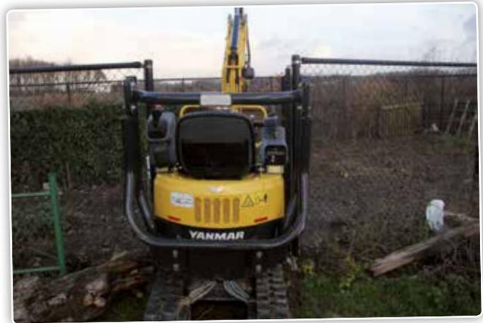
La largeur minimale de cette mini-pelle est de 83. L'arceau de sécurité dépasse de quelques centimètres à gauche et à droite. Cela peut être un désavantage lorsque chaque centimètre compte.
