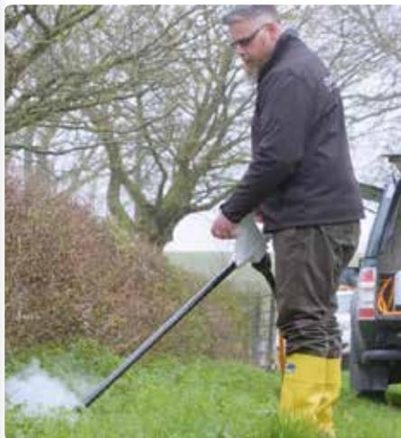
**Le constructeur anglais Ubiquek a développé et construit la Rootwave; une machine qui permet de détruire les adventices à l'aide d'un courant électrique.**
