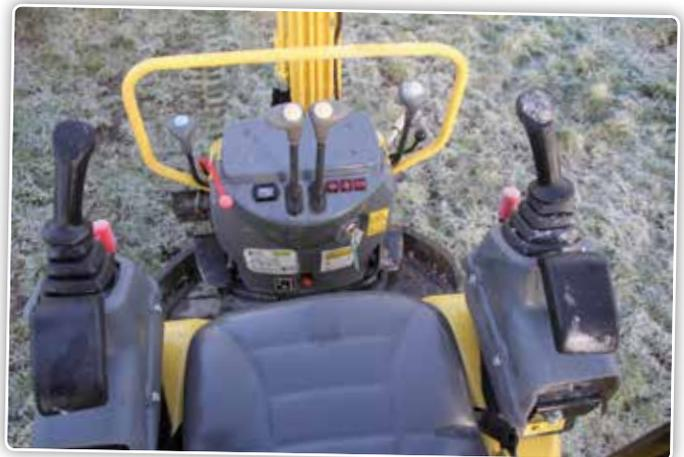
La console de commande: tout est à portée de main et le petit arceau de protection à l'avant permet de reposer ses genoux.
