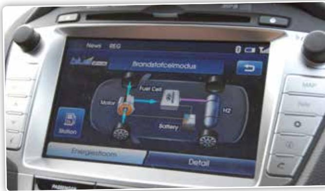
Une pile à combustible assure le stockage d'hydrogène qui va fournir l'électricité pour entraîner la voiture.
