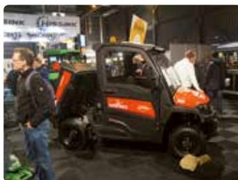
Le concessionnaire John Deere néerlandais GroeNoord a transformé un John Deere Gator XUV 865 M en un véhicule à entraînement électrique alimenté par une pile à combustible, en collaboration avec la société Holthausen clean technologie et la commune de Groningen. Cette dernière a également développé un LM-Trac 286 aussi équipé d'une pile à combustible.
