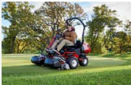
Toro présente la Greensmaster eTriFlex, une tondeuse de greens à entraînement entièrement électrique et qui est construite sur la plate-forme Toro TriFlex bien connue. Cette machine présente l'avantage de ne plus disposer de liquide hydraulique.
