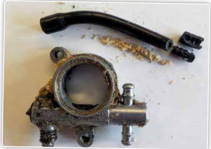
Deze oliepomp met verstopte smeeroleleiding gaf de geest in deze test.
