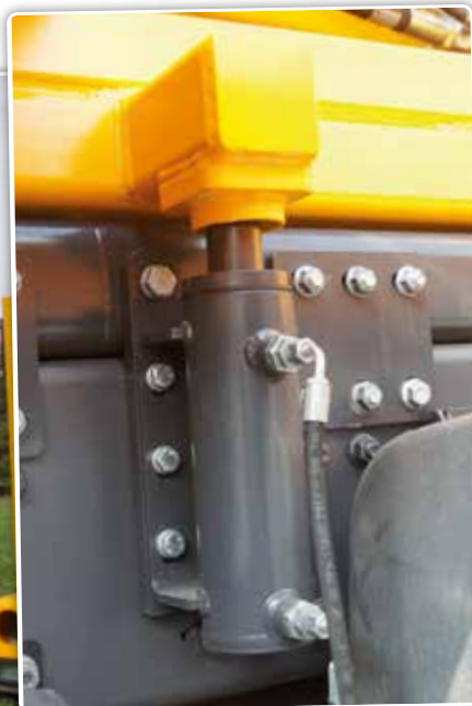
Op het frame zijn vier cilinders gemonteerd om de opbouw eenvoudig af te kunnen zetten.
