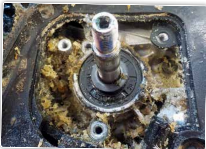
Onder deze oliepompe zit een sterk vervuild motorcarter.
