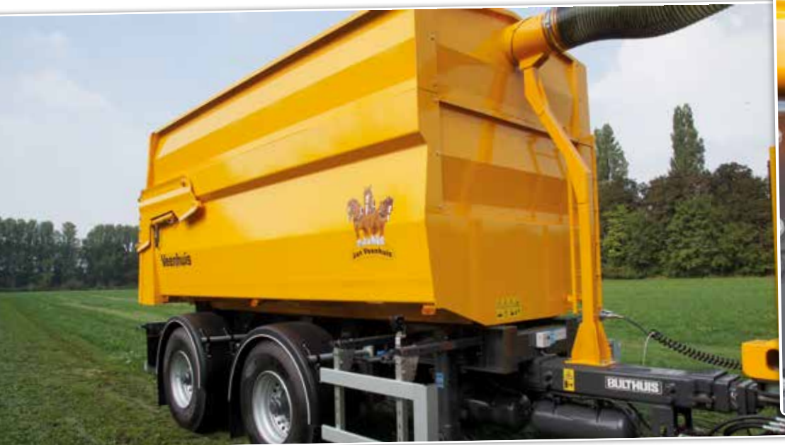
De Jan Veenhuis aanhanger staat op snelverkeerassen en is gebaseerd op een standaard kieper van Jan Veenhuis. Voor de toekomst wordt er uitkeken naar andere varianten: groter, maar ook als opbouw op het draagframe.
