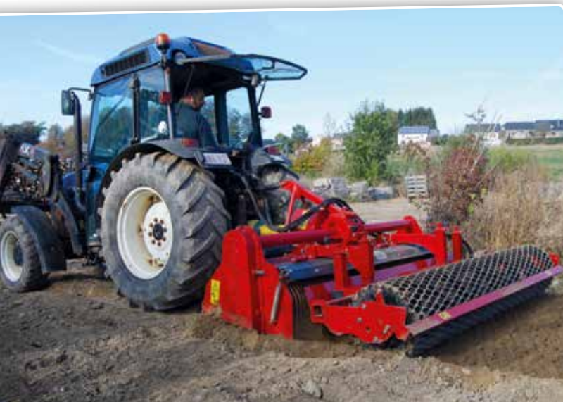
Dankzij een verstelbare niveleerbalk is de bodem goed afgevlakt en is de druk op de bodem homogeen verdeeld over de hele werkbreedte.
