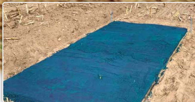
Om de menging te onderzoeken werd een laag blauw zand op de bodem aangebracht.
