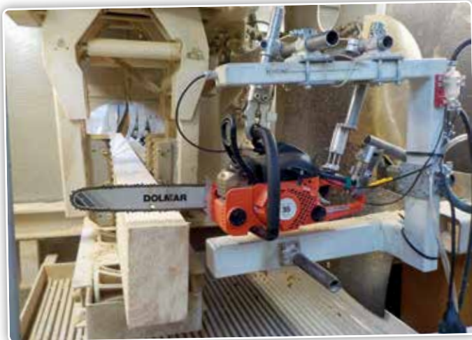
De machines werden gedurende 25 draaiuren op de doorloopstand getest.
