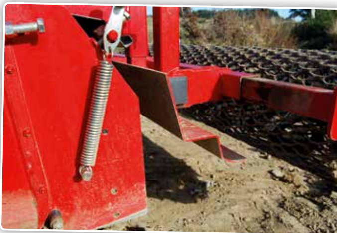
Dankzij een verstelbare niveleerbalk is de bodem goed afgevlakt en is de druk op de bodem homogeen verdeeld over de hele werkbreedte.
