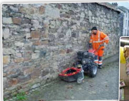
De mechanische onkruidbestrijding gebeurt onder meer met twee borstelmachines van Köppl.
