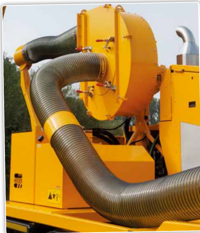
De afzuigventilator is breder gemaakt om bij lagere toerentallen dezelfde capaciteit te hebben als de smalle variant. Hierdoor nemen de slijtage en het brandstofverbruik af en zullen dus de kosten per draaiuur dalen. Herder bekijkt de mogelijkheden voor dit type afzuigventilator op de Herder-maaiarms voor tractoropbouw.
