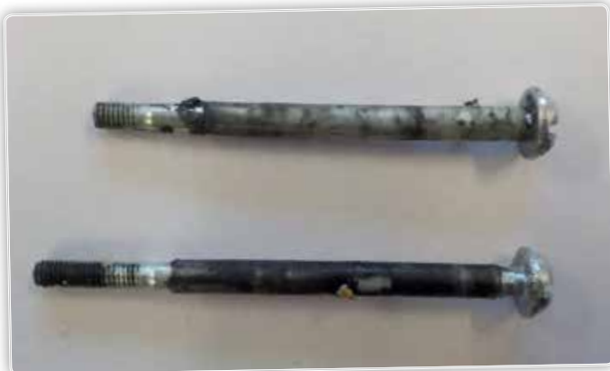
Bij de machine van het merk Hurricane brak tijdens de test de bevestigingsbout van de carburator.
