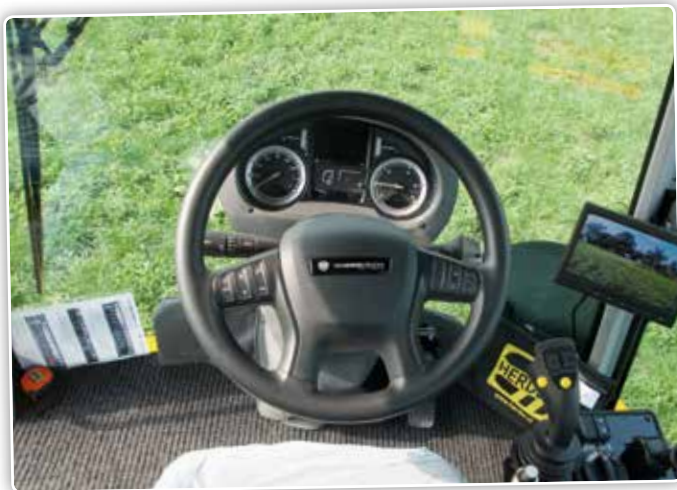
In de cabine is het grootste deel van het dashboard afkomstig van DAF. De bediening van de maaier is de standaarduitvoering van Herder.
