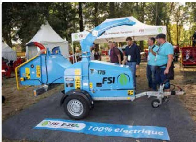
Linddana présente le TP 175, un broyeur de branches à entraînement électrique qui est équipé avec un moteur électrique qui fonctionne en combinaison avec une batterie Lithium-Ion de 96 volts.
