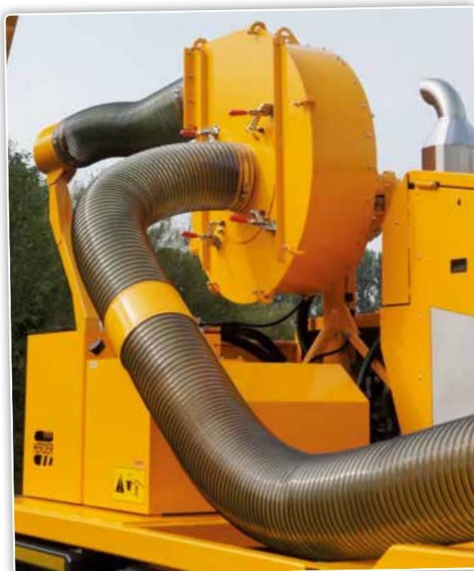
*Le ventilateur d'éjection est plus large afin de garder une même capacité à régime inférieur par rapport à la version étroite. Cela permet de réduire l'usure et la consommation de carburant.*
