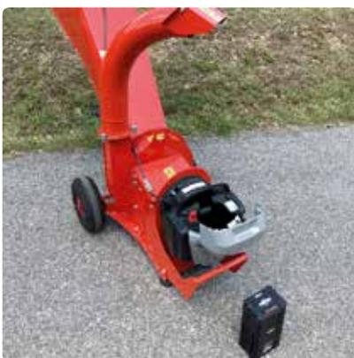
Le constructeur italien Caravaggi présente le TRX50 i-e. Ce broyeur de branches est doté d'un pack de batteries et d'un moteur électrique. Il permet de broyer des branches d'un diamètre maximal de 5 cm.
