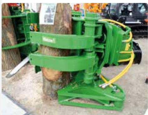
Groeneveldt Grippers a développé un prototype de pince pour les arbres qui combine deux pinces différentes et qui permet d'agripper correctement des arbres déformés.
