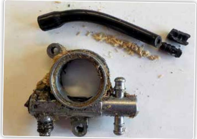
Cette pompe à huile avec conduite de lubrification bouchée a rendu l'âme pendant le test.
