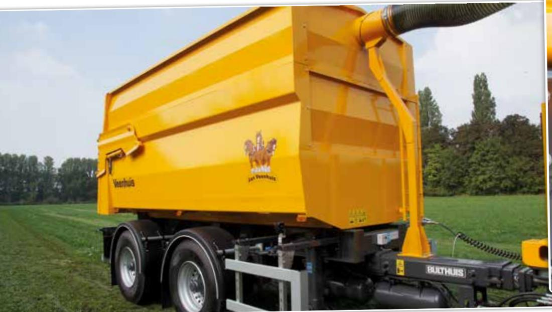
La remorque Jan Veenhuis est dotée d'essieux routiers et repose sur une benne standard de Jan Veenhuis. Pour l'avenir, le constructeur veut également développer d'autres variantes de plus grande capacité, mais également en version portée.
