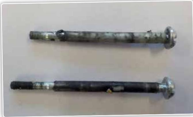
Sur cette machine de la marque 'Hurricane', le boulon de fixation du carburateur a cassé pendant le test.
