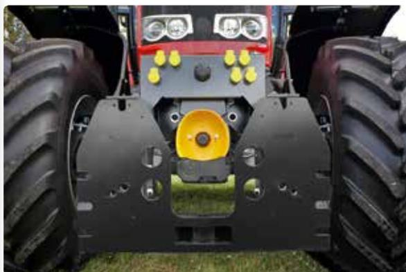
Ce Municipal Frame Carrier dispose de plusieurs points d'attelage, ce qui permet d'utiliser ce cadre d'attelage afin d'y atteler la plupart des lames à neige.
