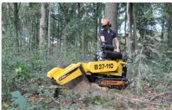
Cette machine sur chenilles est équipée d'un moteur essence Vanguard EFI d'une puissance de 37 ch et travaille sur une largeur de 110 cm.
