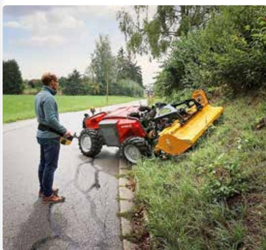
**Le constructeur autrichien Reform présente son porte-outils Metron P48 RC. Un moteur essence entraîne un générateur. L'électricité produite est ensuite stockée dans une batterie, avant d'être transmise aux moteurs de roues.**
