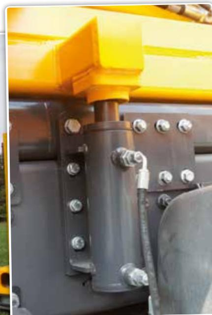
Le châssis comporte quatre vérins intégrés pour remplacer rapidement les outils.
