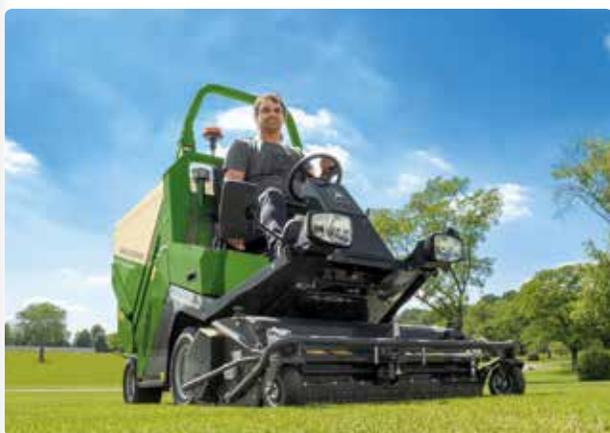
Le constructeur allemand Amazone présente un nouveau groupe de fauche frontal avec broyeur, le Profihopper 1500 SmartLine. Cette machine travaille sur une largeur de 1,50 m et est entraînée par un moteur diesel Yanmar d'une puissance de 45,6 ch.
