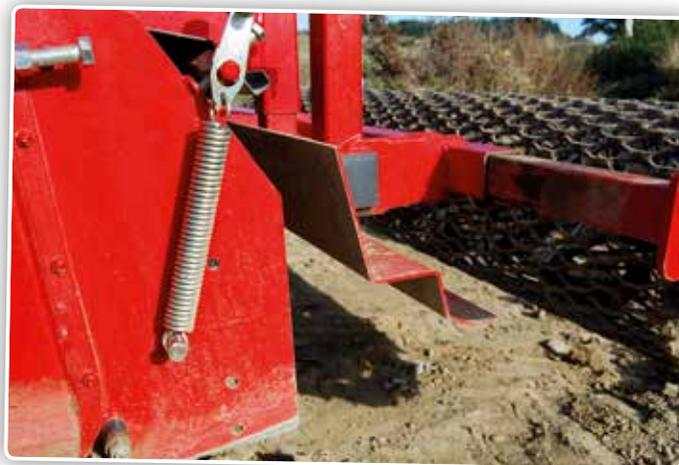
Grâce à la lame niveleuse réglable, le sol est bien planifié et la pression au sol est homogène sur toute la largeur.
