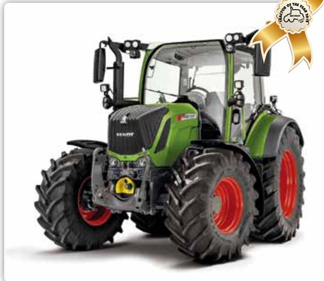
Le jury a par ailleurs été séduit par le Fendt 313 Vario, qui combine une excellente maniabilité avec la technologie la plus récente sur le marché. La transmission à variation continue, la faible consommation de carburant, la cabine moderne avec pare-brise avant d'une pièce, la suspension du pont avant et les nombreuses options en termes d'électronique permettent de disposer d'un tracteur adapté pour tous les types de travaux.
