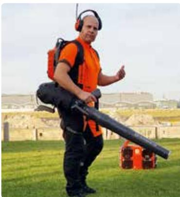
Husqvarna a présenté le 550iBTX à Hambourg; c'est un souffleur de feuilles porté et sur batteries, dont la capacité de travail est comparable à un souffleur de feuilles doté d'un moteur à essence de 50 cc.
