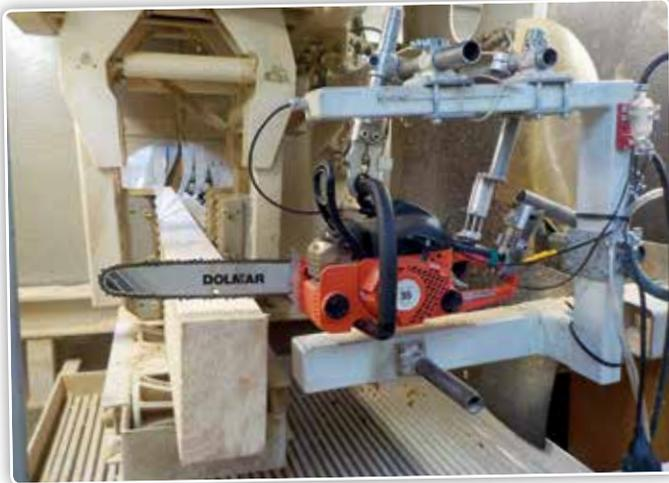
Les machines ont subi un test de 25 heures sur un banc d'essai.
