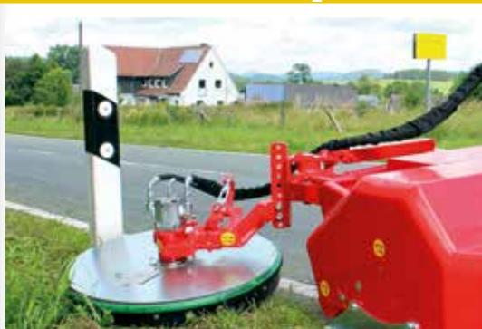
Le constructeur italien Dragone présente une nouvelle faucheuse d'obstacles à entraînement hydraulique et qui travaille sur une largeur de 80 cm.
