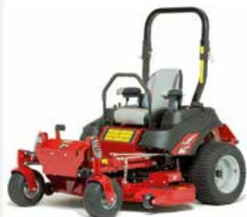
Ferris a présenté dernièrement sa nouvelle tondeuse zéro-turn ISX800Z. Cette tondeuse est entraînée par un moteur Briggs & Stratton d'une puissance de 27 ch.
