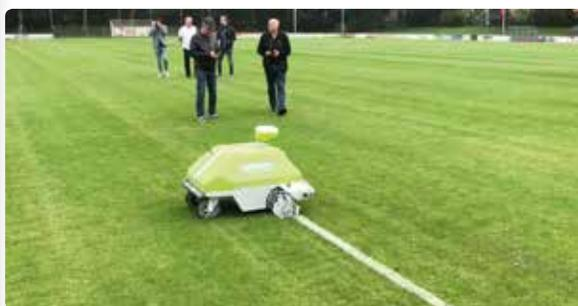
L'Intelligent One est un robot autonome qui permet de tracer les lignes d'un terrain de football en l'espace d'une bonne demi-heure. Entre-temps, le greenkeeper peut mener d'autres tâches à bien.
