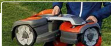
Husqvarna présente un nouveau robot de tonte équipé de quatre roues motrices. Cet Automower 535 AWD est en mesure de travailler sur des pentes allant jusqu'à 70%. Les modèles actuels étaient adaptés pour travailler sur des pentes d'un maximum de 45%.
