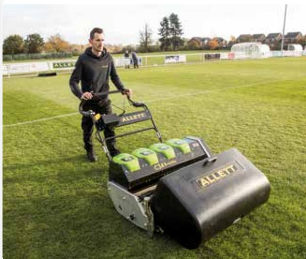
**Le constructeur anglais de tondeuses Allett présente son nouveau modèle C34 Evolution. Cette tondeuse cylindrique électrique pèse 160 kg et est équipée de quatre batteries Li-Ion de 80 volts.**
