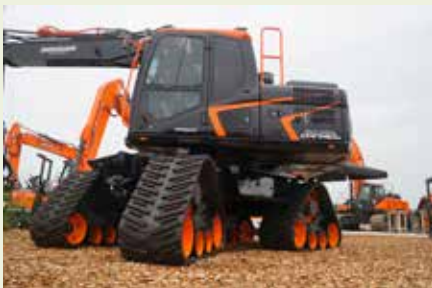
De eyecatcher was deze Doosan DX 140 W 'Quadtrac'. Anema Arum liet het prototype van de rupsen op maat maken. De 25 km/u-rupsen zijn zonder aanpassingen te wisselen voor banden.
