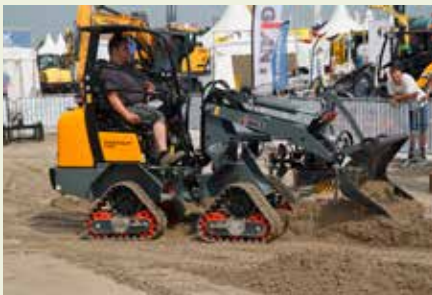
Van dezelfde orde is deze quadtrac-wiellader, waarvoor Tobroco Giant zelf de rupsen ontwikkelde. Hij verkeert nog in het prototype stadium en is op termijn mogelijk een optie voor alle Giant-wielladers.
