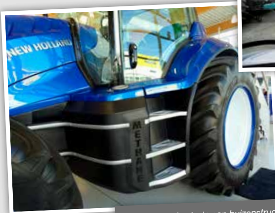
De brandstoftanks in een buizenstructuur in meerdere lagen uit composietmateriaal zitten in delen vooraan de trekker en aan de zijkant onder de cabine.
