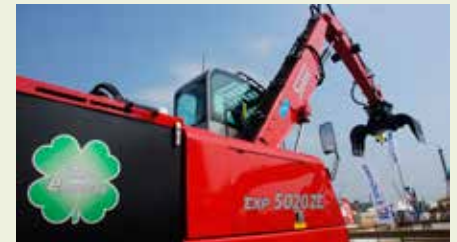
De volledig elektrische Solmec-overslagmachine bij Hansan past in het duurzaamheidsverhaal. Ze heeft twee enorme batterijpakketten, waarmee je een dag kunt werken. Daarna moet de machine weer aan het net.
