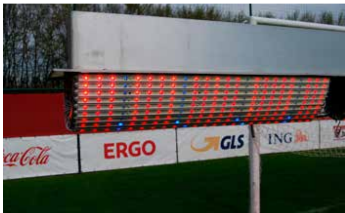
De led-elementen combineren 4 verschillende golf lengtes met specifieke optische lenzen om de grasmat optimaal te laten groeien.
