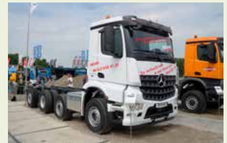
Omdat je meestal toch op de verharding blijft, scoorde Veldhuizen Wagenbouw met deze van 6x2 naar 8x2 omgebouwde Mercedes met een GVW van 41,5 ton en een gestuurd wide-spread-assel aan de achterkant.
