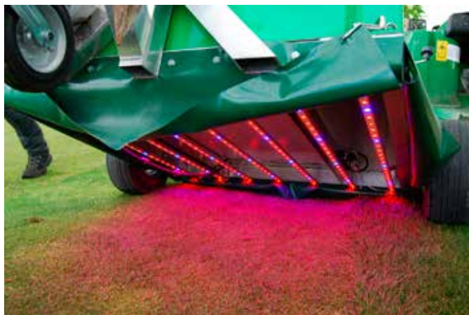
De Turtle bestaat uit 7 ledstrips en biedt dezelfde voordelen als de grotere Phoenix.
