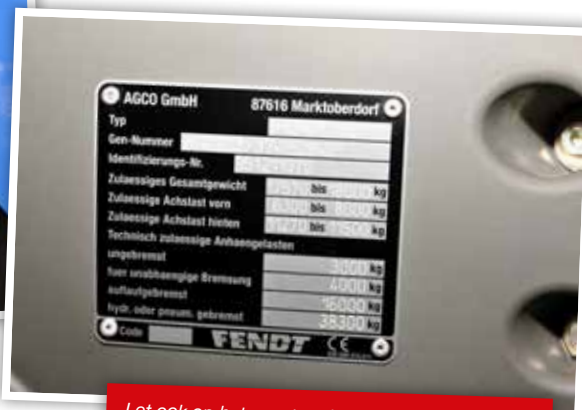
Let ook op het constructieplaatje van een trekker om te zien hoeveel deze maximaal mag trekken.
