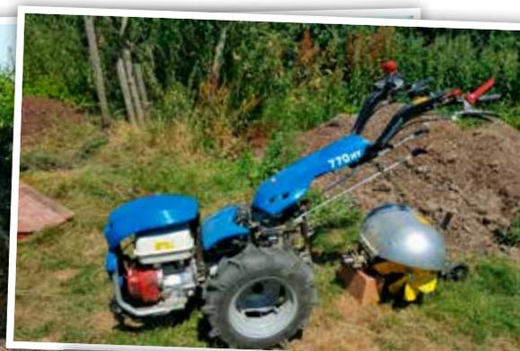
En détachant la broche de sécurité, l'accessoire se démonte facilement pour être remplacé par un autre. Le remplacement d'une machine par une autre ne prend pas 5 minutes.
