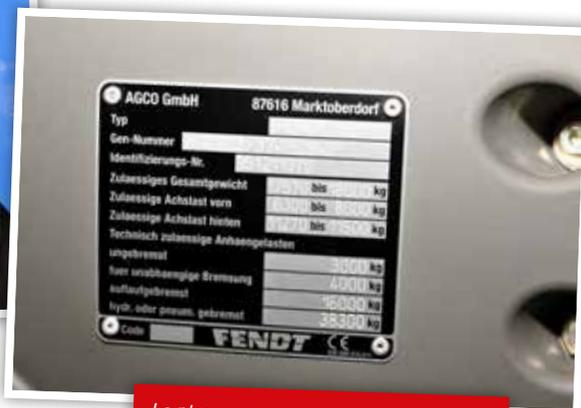
La plaque constructeur indique la charge maximale que le tracteur peut tracter.
