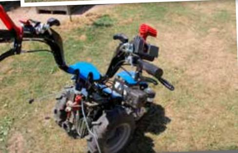
En poste inversé, la colonne de direction passe entièrement de l'autre côté, y compris pour la commande des gammes et de la prise de force.
