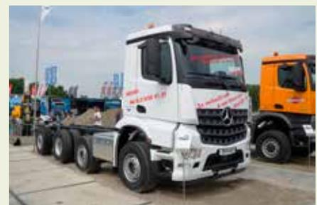
Comme la plupart des camions évoluent sur des surfaces en dur, Veldhuizen Wagenbouw a présenté un Mercedes adapté d'un 6x2 vers un 8x2 avec une MMA de 41,5 tonnes et un essieu directeur wide-spread à l'arrière.
