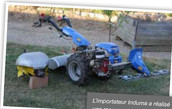
*L'importateur Induma a réalisé une masse avant démontable.*
