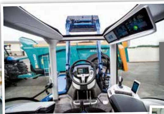
20% de surface vitrée en plus, un éclairage plus performant et un tableau de bord futuriste caractérisent le design de la nouvelle cabine.
