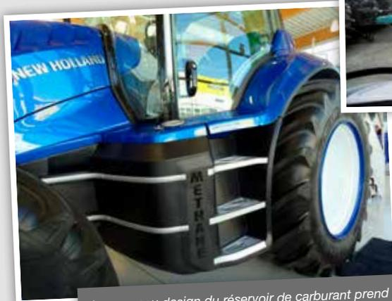
Le nouveau design du réservoir de carburant prend la forme d'une structure tubulaire en matériau composite, située en partie à l'avant et en partie en-dessous de la cabine.
