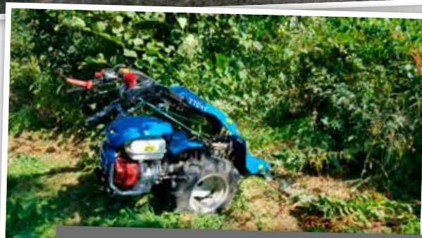
*En poste inversé, la machine reste aussi maniable qu'en utilisation classique. De ce fait, la fauche de coins reste très facile et précise, et la machine réagit avec précision aux commandes.*
