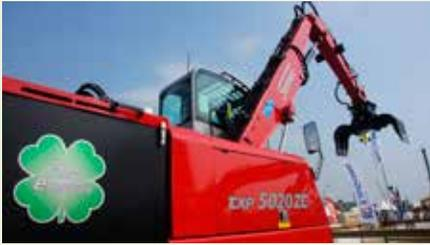
Hansan présentait la grue Solmec entièrement électrique, et qui se veut durable. La machine est équipée de deux énormes batteries, qui permettent de travailler toute une journée avant de les recharger.
