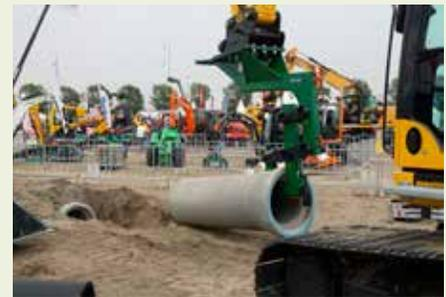
Pour ceux qui veulent limiter la main d'oeuvre et augmenter la sécurité: cette nouvelle Nimatec permet de prendre, placer et raccorder des buses d'évacuation. Il suffit ensuite de refermer le trou et de tasser le tout.
