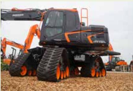
Doosan a attiré les regards avec cette Doosan DX 140 W 'Quadtrac'. Anema Arum a développé ce prototype de chenilles sur mesure. Ces dernières permettent de se déplacer à 25 km/h et se remplacent sans adaptation par des pneus.
