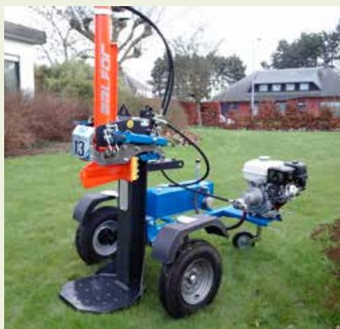
**Le constructeur italien de fendeuses Balfor propose à présent ses modèles Pro Vk 650 Combi avec deux moteurs. Un moteur essence Honda est combiné avec un moteur électrique de 220V. En fonction de la situation, il est ainsi toujours possible d'opter pour l'entraînement le plus adapté.**
