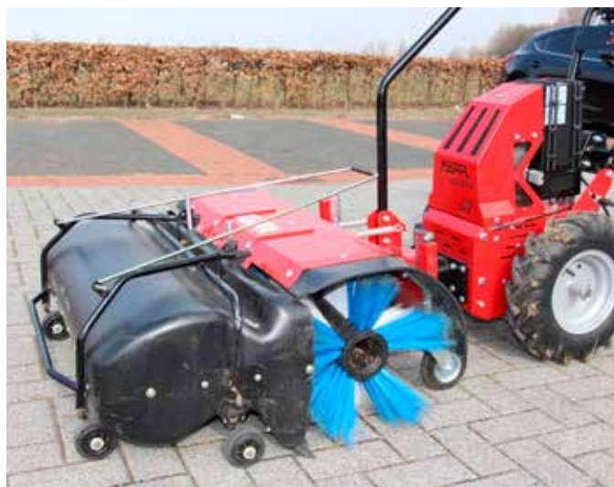
De werktijd van de accu hangt in sterke mate af van het gebruikte hulpstuk: een aangedreven werktuig zoals een veegborstel vraagt veel meer vermogen.
