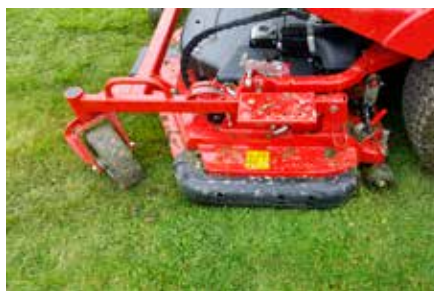
Het maaidek kan vanaf de bestuurszetel bediend worden en de hoogte ingesteld van 2 tot 11 cm.
