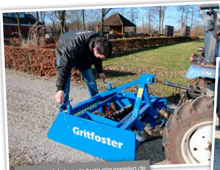
Met spindels kan via twee steunwielen de bewerkingsdiepte worden ingesteld.
