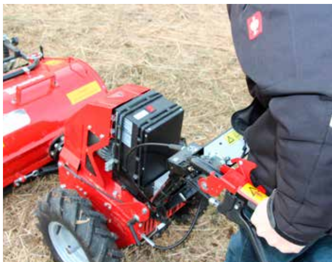
De regeling van het toerental, de noodstop en het inschakelen van de aftakas aan het linker handvat zitten samen gegroepeerd op de stuurboom.
