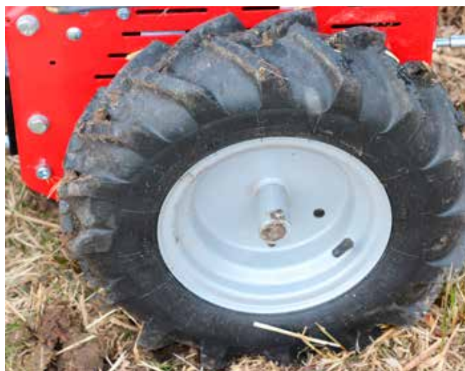
Het basismodel heeft standaard wielen 4.00x8 AS met wielvrijloop. De as heeft wikkelbescherming om te voorkomen dat lang gras zich bij het maaien om de as heen wikkelt en daardoor de oliekeerringen kapot gaan.
