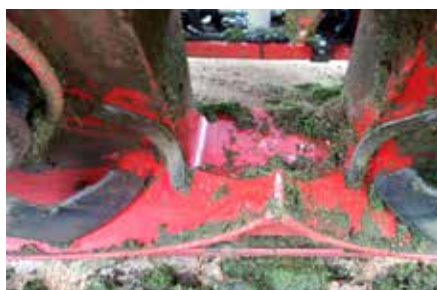
Aan het uiteinde van het maaidek zit een systeem (maaidekwisser) dat iedere keer als de bak geleegd wordt de uitgang van het dek reinigt.
