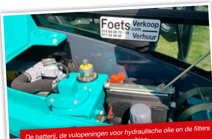
Alle punten voor dagelijks onderhoud zijn gemakkelijk bereikbaar.
