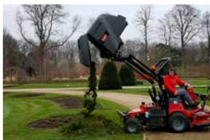
In de opvangbak van 810 liter zit een verdeler die ervoor zorgt dat de bak optimaal gevuld wordt. Als de bak bijna vol zit, geeft een sensor dat aan en wordt de aftakas uitgeschakeld.
