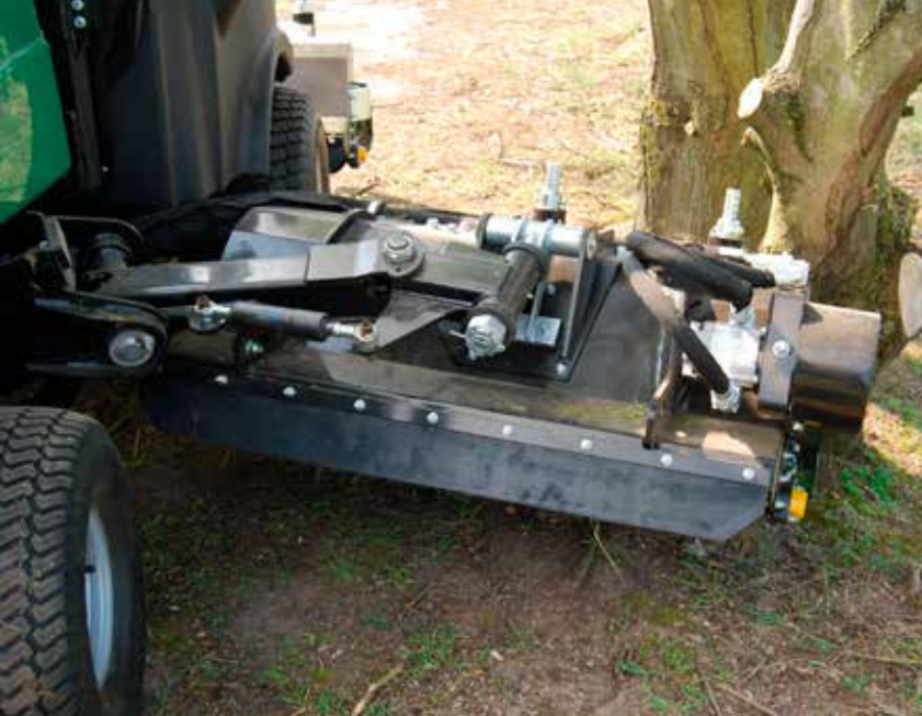
De maaiers van de HM 600 zijn voorzien van een aanrijbeveiliging die de maaielementen wegklapt als er een obstakel wordt geraakt.
