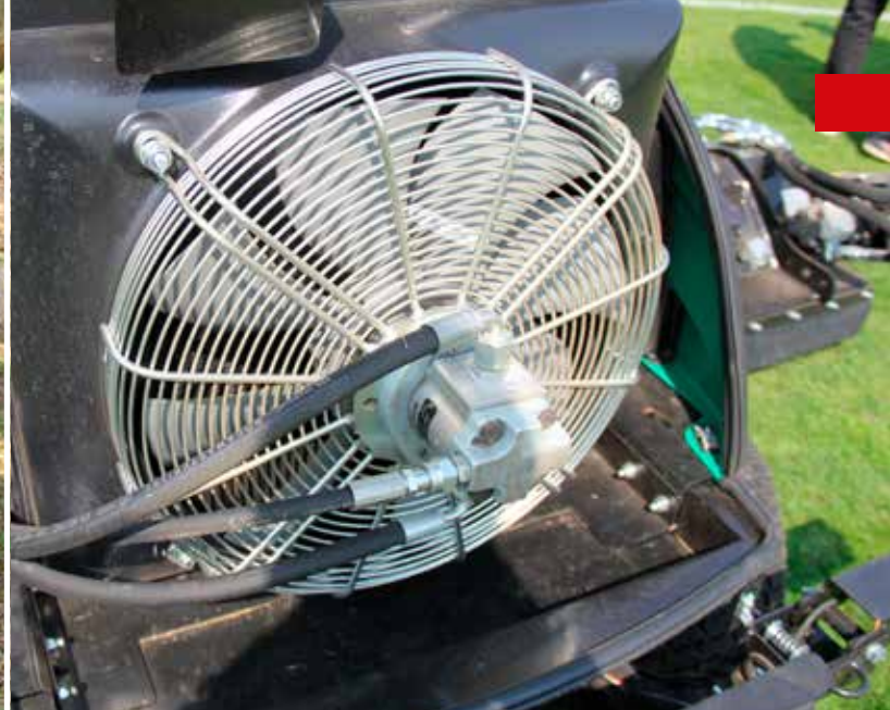
Nieuw en heel zinvol bij het maaien in droge omstandigheden is de hydraulisch aangedreven en omkeerbare radiatorschroef die de radiator schoon houdt.
