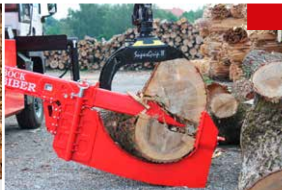
De Spaltbiber is een klieftang waarvan de zwaarste een stam van 110 cm in twee kan splijten.
