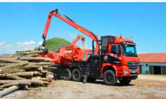
De Turox is een versnipperaars die op een 8x8-Mercedes vrachtwagen staat gemonteerd en diameters tot 75 cm aan kan. De aandrijving wordt verzekerd door een 630 pk-Mercedesmotor.
