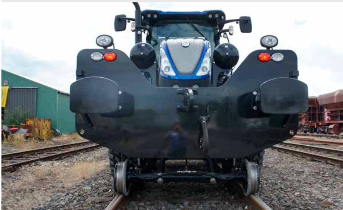
Het basisonderstel werd uitgebreid met speciale stootblokken en een aankoppeling voor wagons.
